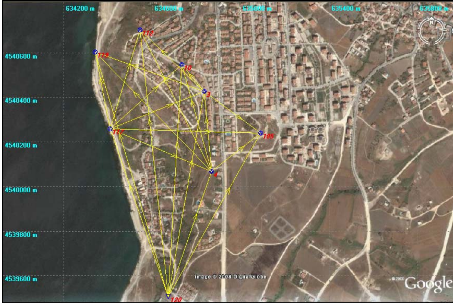
Şekil 4.5 : Gürpınar heyelan bölgesi ve çevresinde deformasyonların belirlenmesi için tesis edilen jeodezik kontrol ağı(Url-11).
