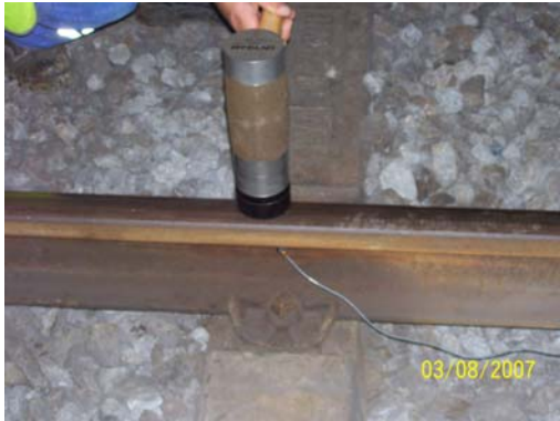
Şekil 5.2 : Balastlı yolda mesnet noktasında çekiç darbe testi.
