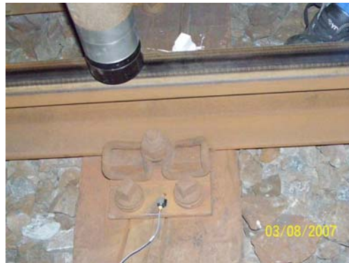
Şekil 5.2 : Balastlı yolda mesnet noktasında çekiç darbe testi.
