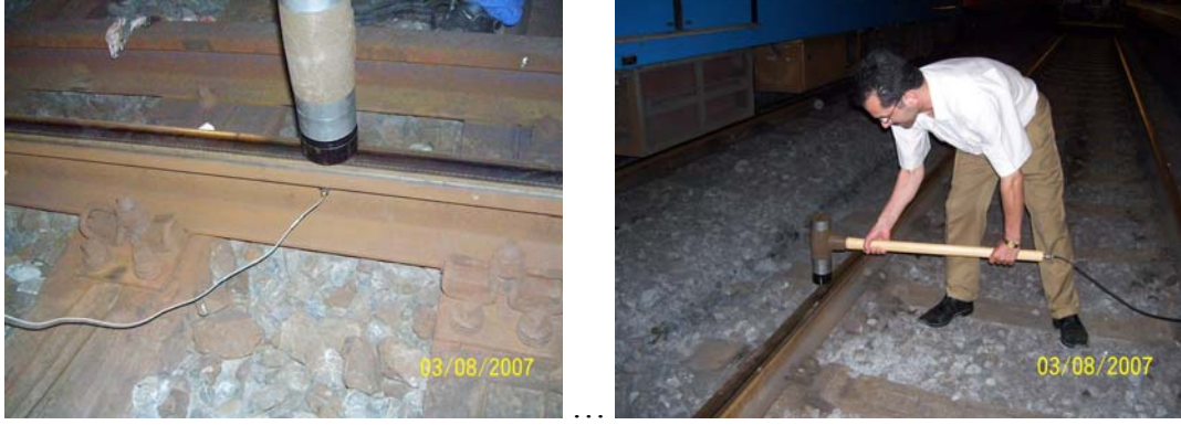
Şekil 5.3 : Balastlı yolda iki mesnet ortasında çekiç darbe testi.
