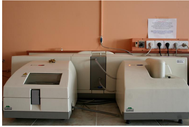
Şekil 4.29 : Malvern Mastersizer 2000 tane boyutu ölçüm cihazı.
