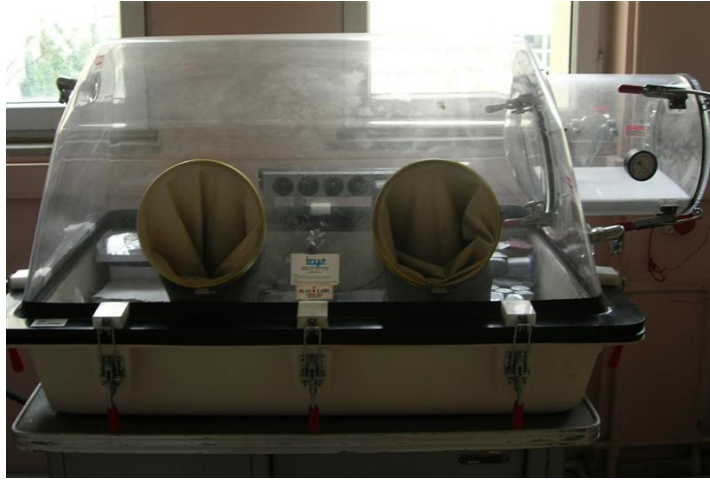
Şekil 4.18 : Kapalı ortam kutusu (Glove-Box).
