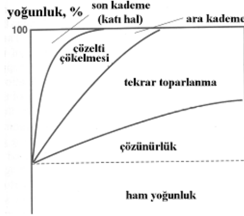
Şekil 2.11 : Sıvı faz sinterlemesinde yoğunluk ile sıvı faz miktarı arasındaki değişim.
