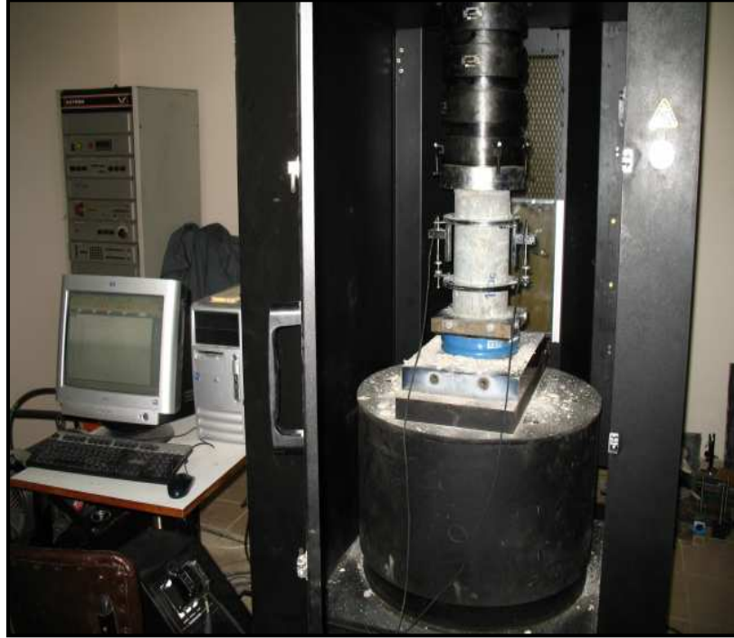
Şekil C.4b : Silindir basınç ve elastisite modülü deneyi.
