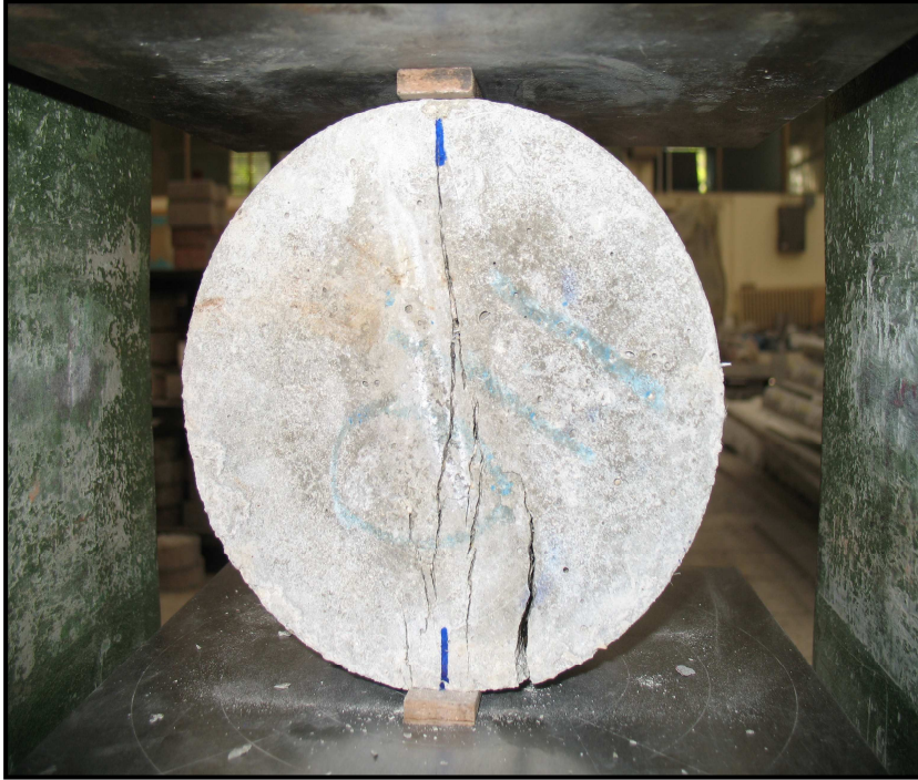
Şekil C.5b : Disk yarma çekme numunesi yerleşim düzeni ve deney sonrası.
