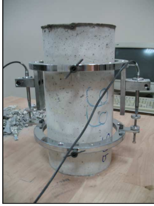
Şekil C.4a : Kapalı çevrimli deplasman kontrollü basınç deney cihazında kullanılan silindir numune ve deformasyon ölçümleri için aparatlar.
