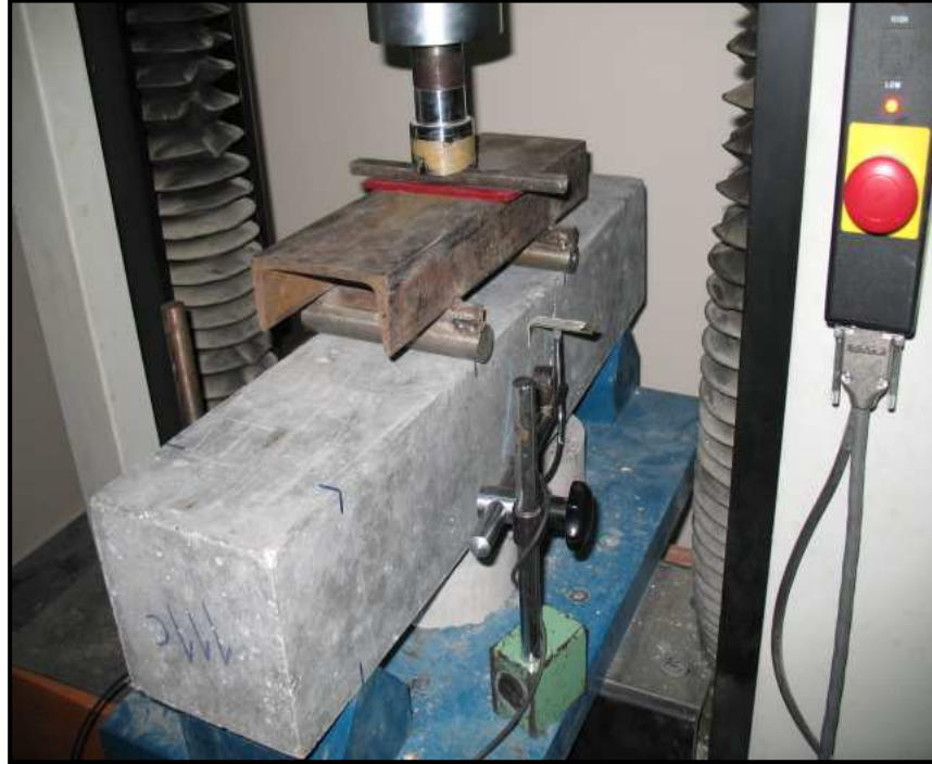
Şekil C.6b : Kiriş numunesinin yerleşim düzeni ve eğilme deneyi.
