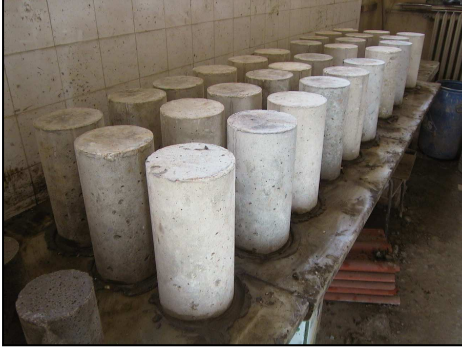
Şekil B.1 : Başlık yapılmış silindir numuneler.
