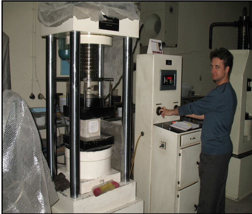
Şekil C.2 : Yük kontrollü küp basınç deneyi.
