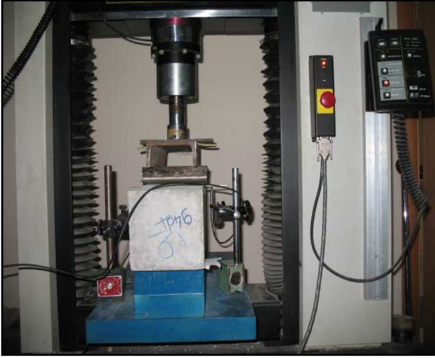
Şekil C.6c : Eğilme etkisindeki kiriş numunesinin deney düzeni.
