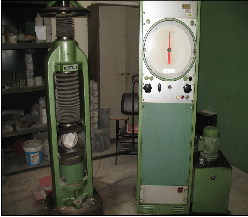
Şekil C.5a : Disk yarma çekme deneyi.
