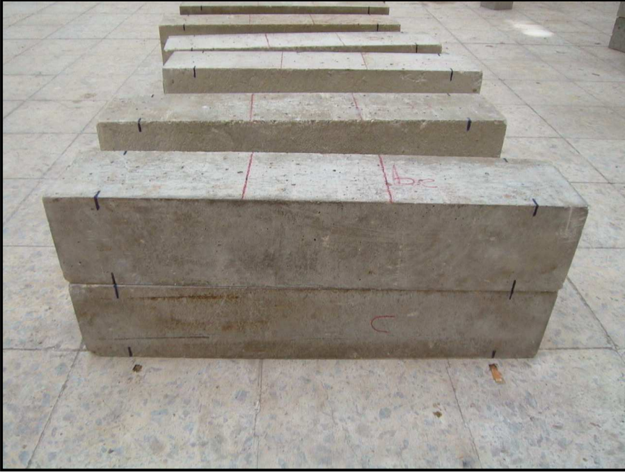
Şekil B.3 : Yükleme noktaları işaretlenmiş kiriş numuneler.
