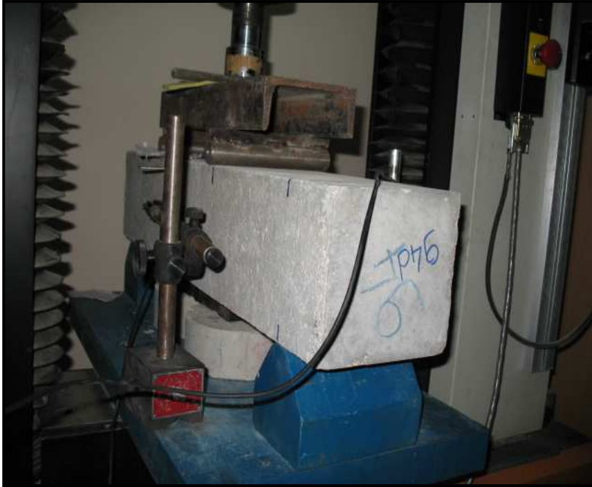
Şekil C.6d : Eğilmeye tabi tutulan kiriş numunesinin deney düzeni.
