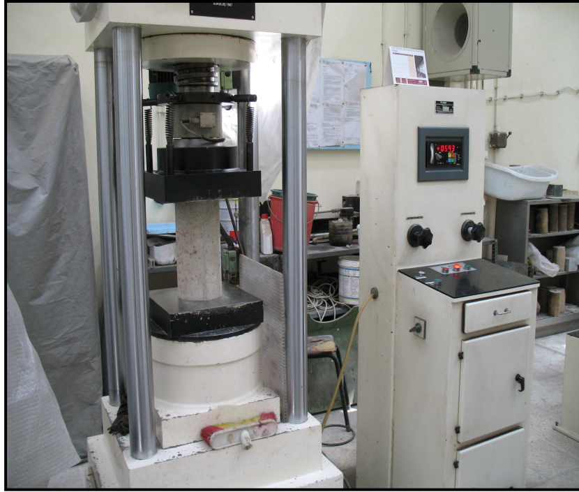
Şekil C.1 : Yük kontrollü silindir basınç deneyi (1. ve 2. Grup).
