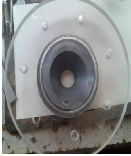
Şekil 3.16 : Konik hale dönüştürülmüş giriş yapısı.
