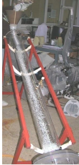
Şekil 3.13 : Malzemenin kolona yerleştirilmesi için kullanılan düzenek.
