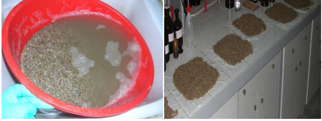
Şekil 3.24 : Kum için uygulanan ön işlemler: Yıkama ve kurutma.
