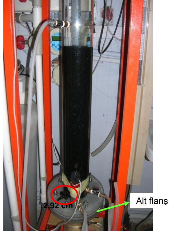
Şekil 3.10 : 4 cm lik ve 10 cm lik kolonda piyezometre musluklarının yerleşimi.
