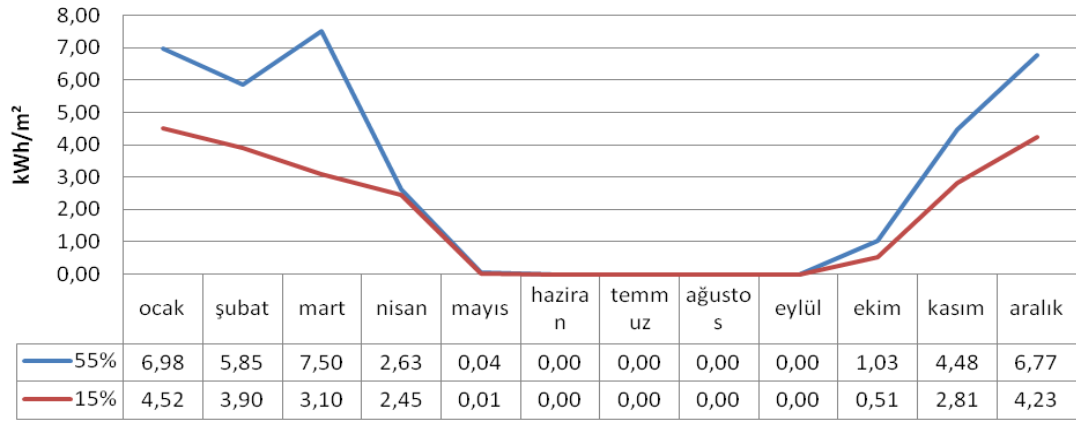
Şekil 4.12 : BepTr kısa kenarı güneye yönelen ve saydamlık oranı 55 % ve 15 % için aylık ısıtma ihtiyacı karşılaştırması.
