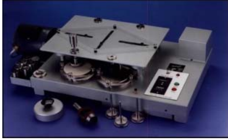
Şekil 2.18 : Martindale Aşındırma Cihazı (Kahraman, B., 2006).
