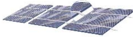
Şekil 2.22 : Kristal silisyum hücrelerin elektrik bağlantıları [29].
