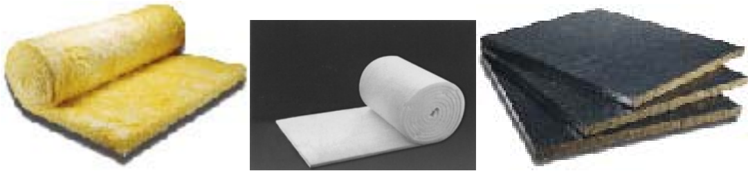
Şekil 3.68 : Şilte formunda cam yünü; rulo seramik yünü; levha formunda taşyünü.
