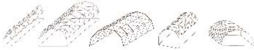
Şekil 3.18 : Tonozsal uzay kafes örnekleri [42].
