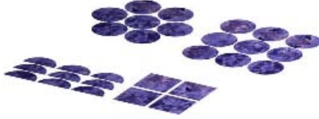
Şekil 2.21 : Farklı hücre formları ve dizilimleri [20].
