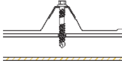
Şekil 3.59 : Trapez levhaların vida ile tespiti.
