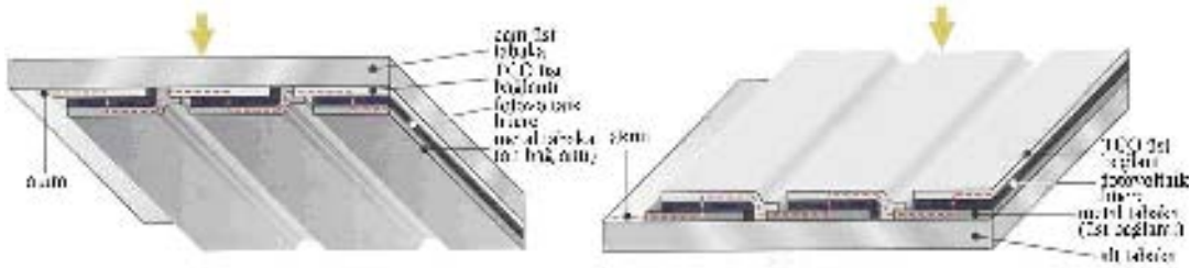
Şekil 2.23 : İnce film hücrelerin elektrik bağlantıları [29].
