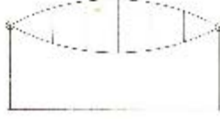
Şekil 3.38 : Çift çeperli şişirme örtü sistemleri [42].
