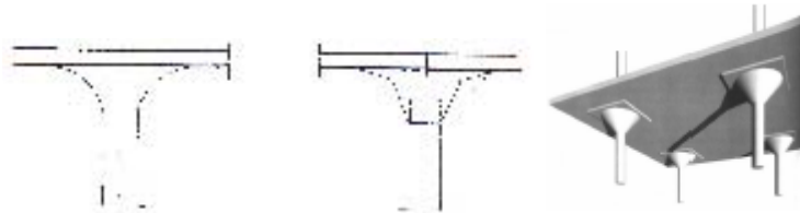
Şekil 3.26 : Mantar döşeme-kolon birleşimleri.
