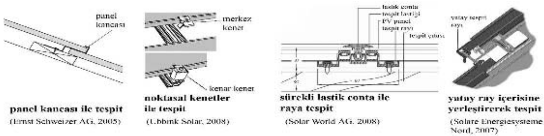
Şekil 4.27 : Modül tespitinde kanca, kenet, conta ve ray kullanımı [111, 134, 136, 144].
