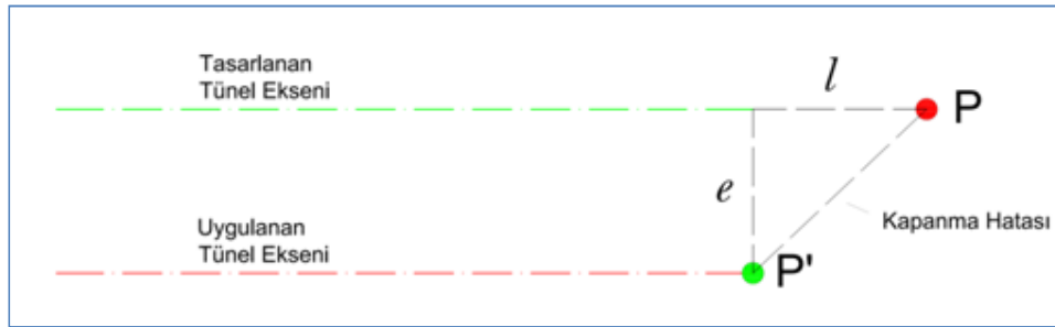
Şekil 3.15: Tünel doğrultu hatası (Fowler S., 2006)
