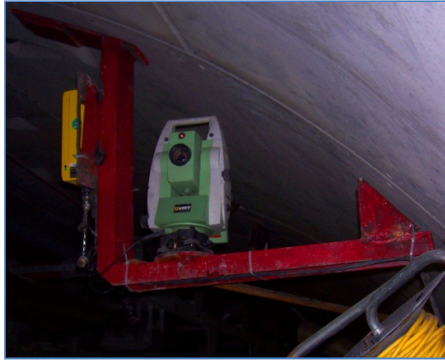
Şekil 2.9: Total station kurulmuş yönlendirme konsolu (Ademoğlu Y., 2009)
