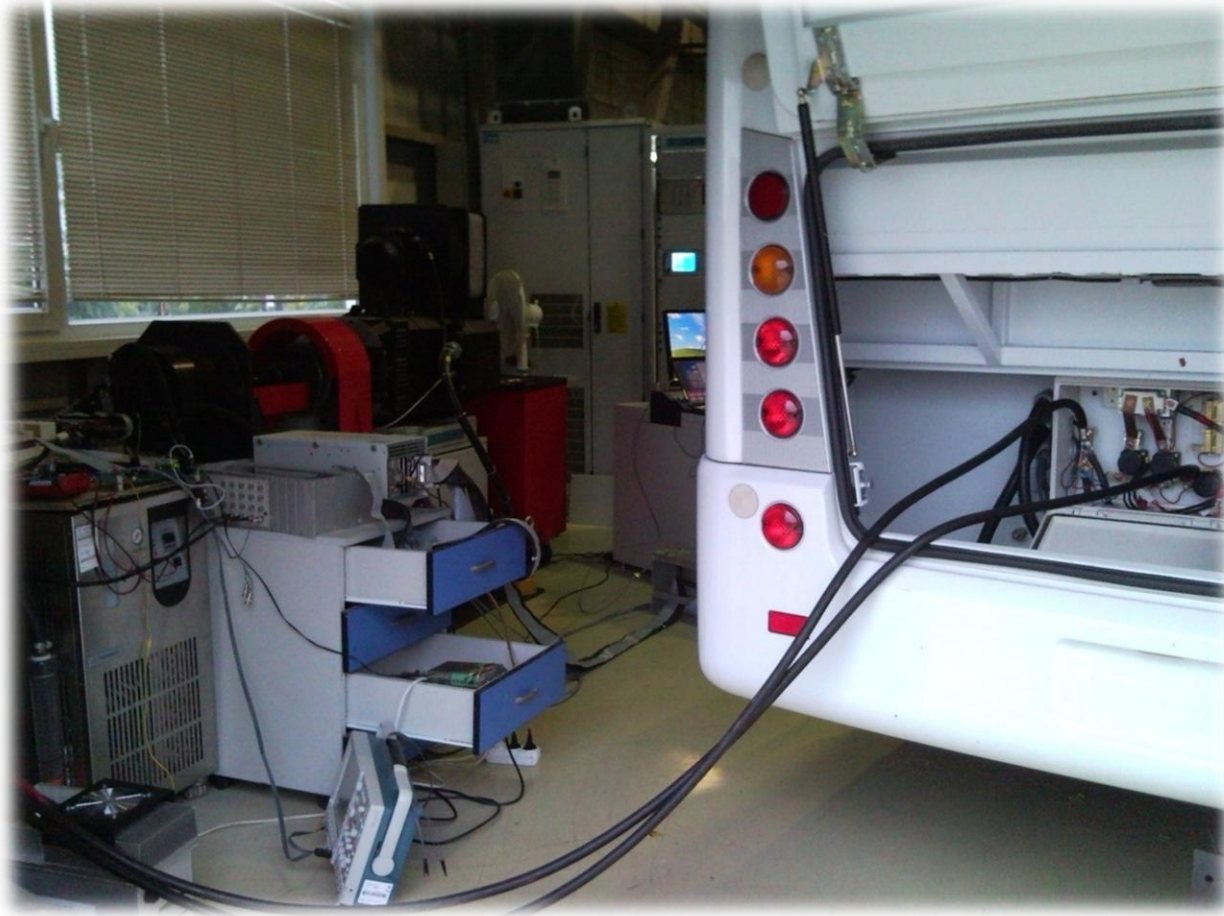
Şekil B.1 : Sisteme araç bataryasının bağlanması
