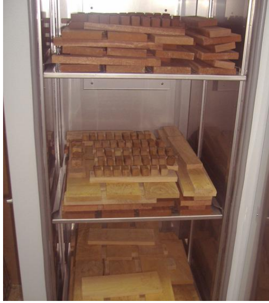
Şekil 4.3: Numunelerin Fırında Kurutulması.
