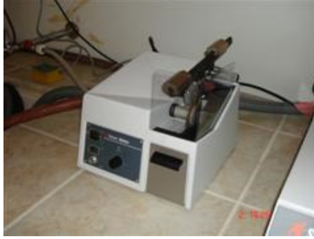
Şekil 3.8 : Minitom™ marka hassas kesme cihazı
