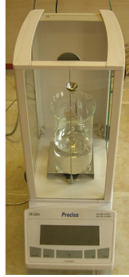
Şekil 3.12 : Precisa™ marka hassas terazi ve yoğunluk ölçüm aparatları.
