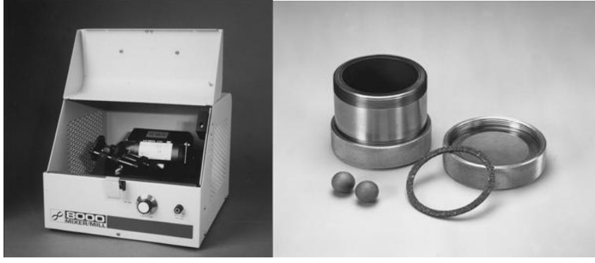
Şekil 3.1 : SPEX 8000 serisi karıştırıcı/öğütücü ile WC kap ve bilyalar.
