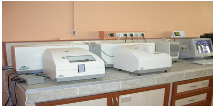
Şekil 3.3 : Malvern™ Mastersizer tane boyut analizi cihazı.
