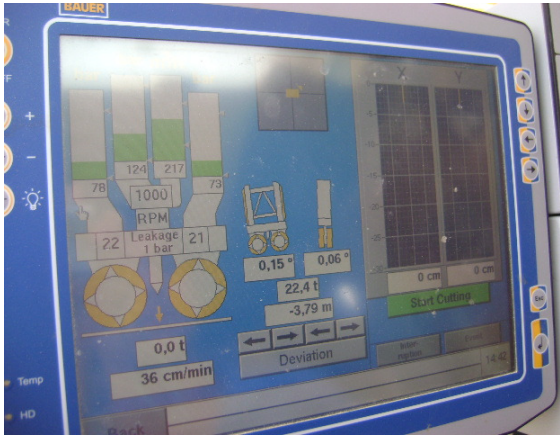
Şekil 3.11 : Operatör kabini içindeki bilgi ekranı ve düşeyde yön kabiliyeti
