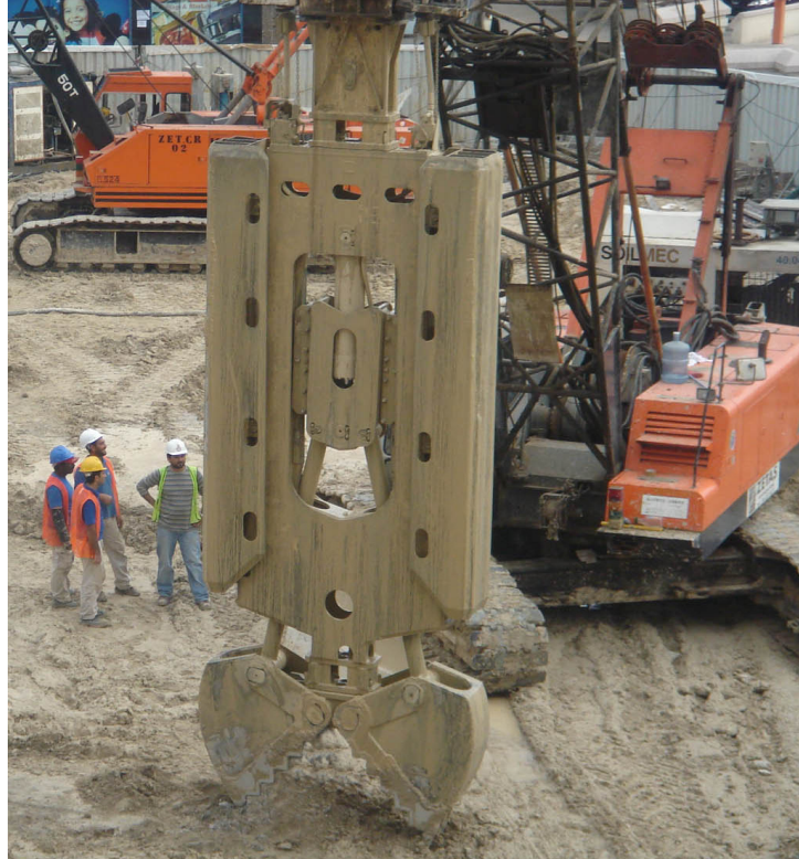
Şekil 3.12 : Hidrolik grab kazıcı
