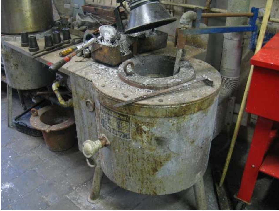
Şekil 6.9 : Döküm alaşımı eritme ocağı.
