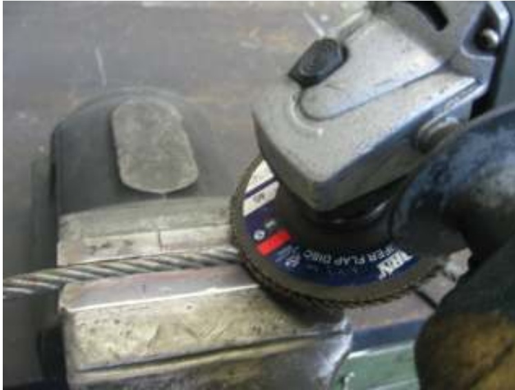
Şekil 6.51 : Abrasif aşınma için kullanılan el tipi taşlama makinesi.
