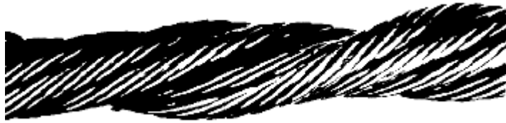
Şekil 5.9 : Halat çapında bölgesel küçülme [12].
