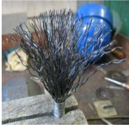
(b) kimyasal temizlenmiş halat ucu
