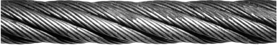
Şekil 5.1 : Dış abrasif aşınmaya uğramış halat [6].
