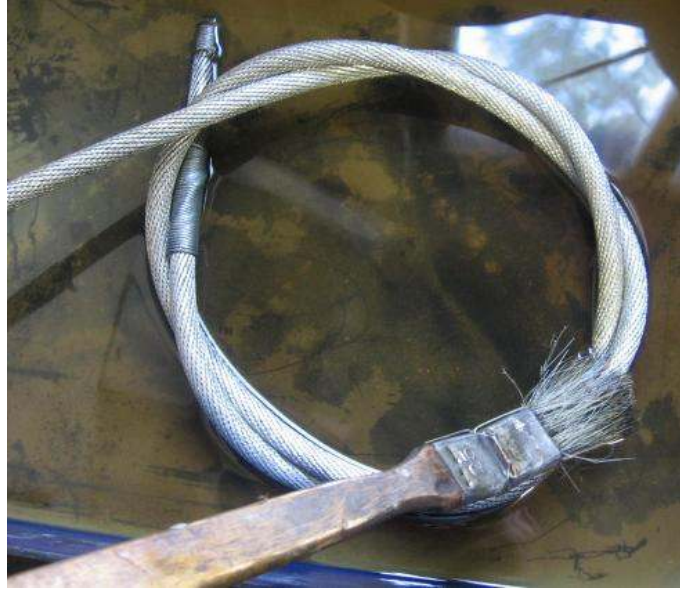
Şekil 6.41 : Halat yüzeyindeki yağın tel fırça ile uzaklaştırılması.
