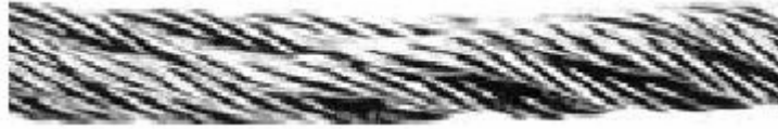
řekil 5.10 : Çok demetli bir halatın tambur üzerine yanlış sarılmasının sebep olduęu yassılařmış kısım [38].
