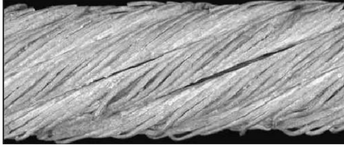
Şekil 5.14 : Uzun süre yüksek sıcaklığa maruz kalmış halat [32].
