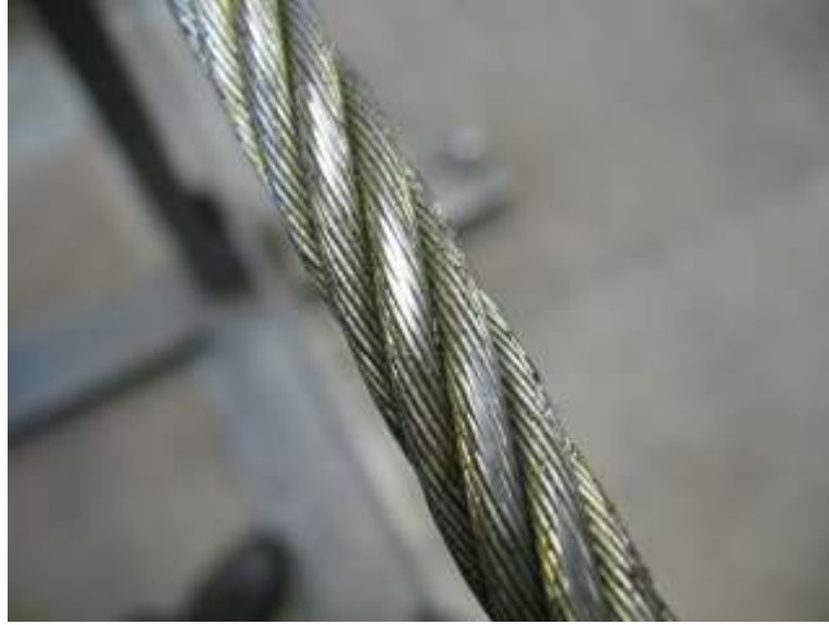
Şekil 6.52 : Abrasif aşınmış 6 x 36 Warrington-Seale halat.
