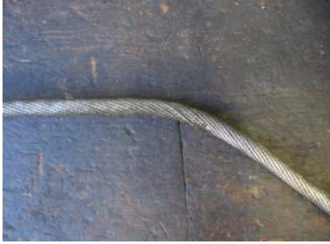
Şekil 6.48 : 35° bükülmüş 39 demetli dönme dirençli halat.
