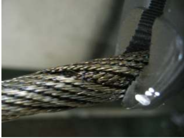
Şekil 6.46 : İç tel kırıklarının yaratılabilmesi için belirli uzunluğu açılan halat numunesi.
