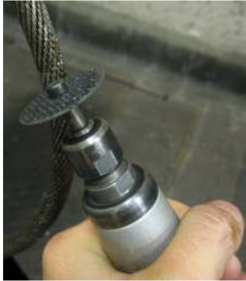
Şekil 6.45 : İç tel kırıklarının yaratılması için kullanılan küçük taşlı taşlama makinesi.
