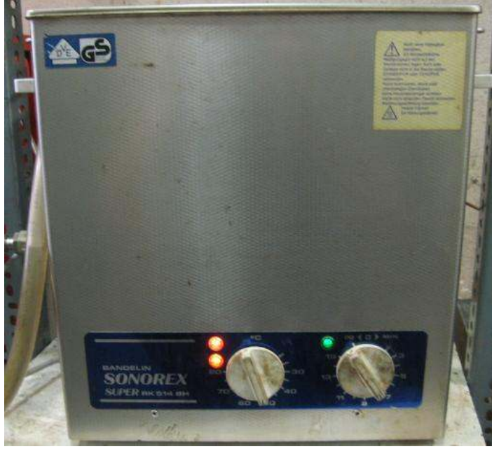
Şekil 6.42 : Bandelin Sonorex SuperRK 514 BH model ultrasonik temizleme cihazı.
