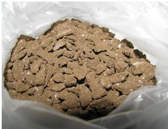
Şekil 5.3 : Yapısal analizler sonrasında çevresel analizlerde kullanılmak üzere parçalanmış S/S blok numuneleri.
