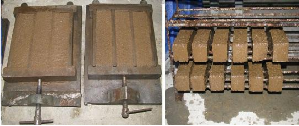
Şekil 5.2 : Kalıplara dökülen pasta örnekleri ve kalıptan çıkarılan S/S blokları.
