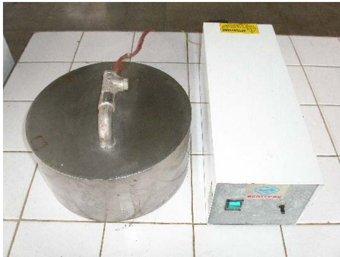
Şekil 5.5 : Tambur tipi ultrasonik titreşim cihazı.
