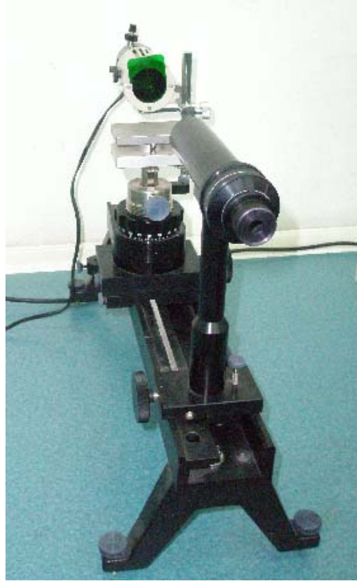
Şekil 5.7 : Temas açısının ölçüldüğü goniometre cihazı.
