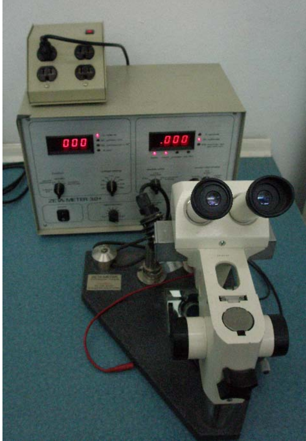
Şekil 5.10 : Zeta Meter 3.0 cihazının görünümü.
