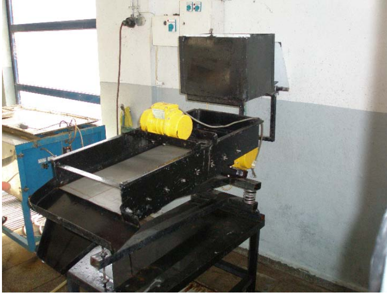
Şekil 5.3 : Yüksek frekanslı titreşimli susuzlandırma eleği.
