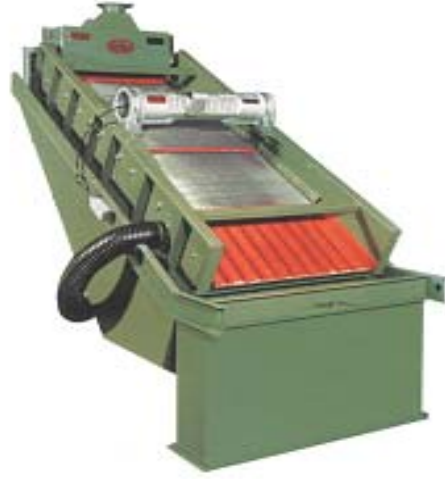
Şekil 3.5 : Derrick eleğinin şematik görünüşü (Önal ve diğ., 1986).
