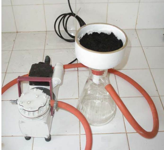
řekil 6.44 : Filtrasyon iřlemlerinin yapıldıęı deney dzeneęi.
