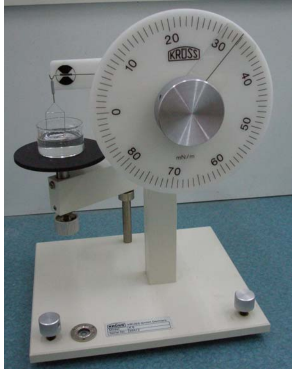
Şekil 5.6 : Yüzey geriliminin ölçüldüğü Du-Nou tensiyometresi.
