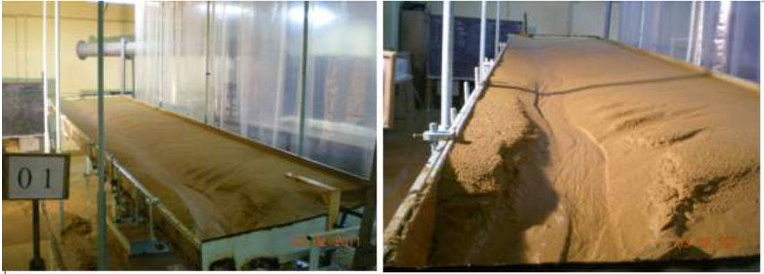
Şekil 4.7: %5 enine-%5 boyuna eğimde, 105 mm/sa'lik yağış altında yapılan deney sonrası mikrotopografyanın görünümü.
