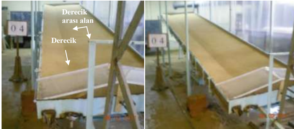
Şekil 4.2: Erozyon kanalında yağış öncesi oluşturulan derecik.
