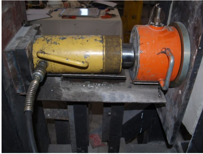
Şekil 2.22 : Hidrolik kriko ile kolona aksenal yük verilmesi işlemi
