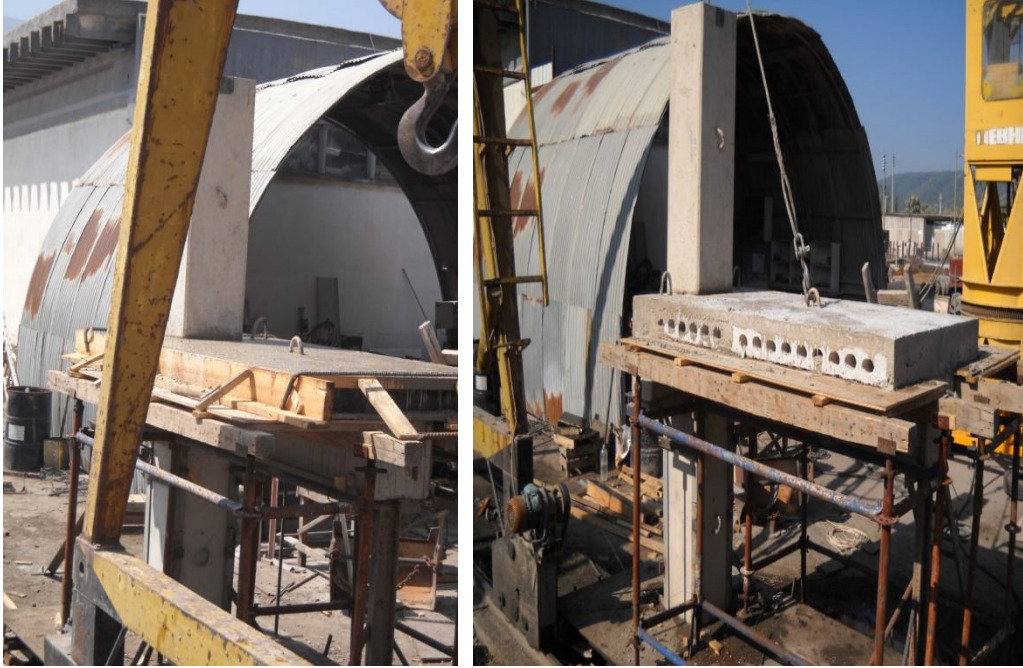
Şekil 2.19 : Numunenin kalıptan çıkarılması
