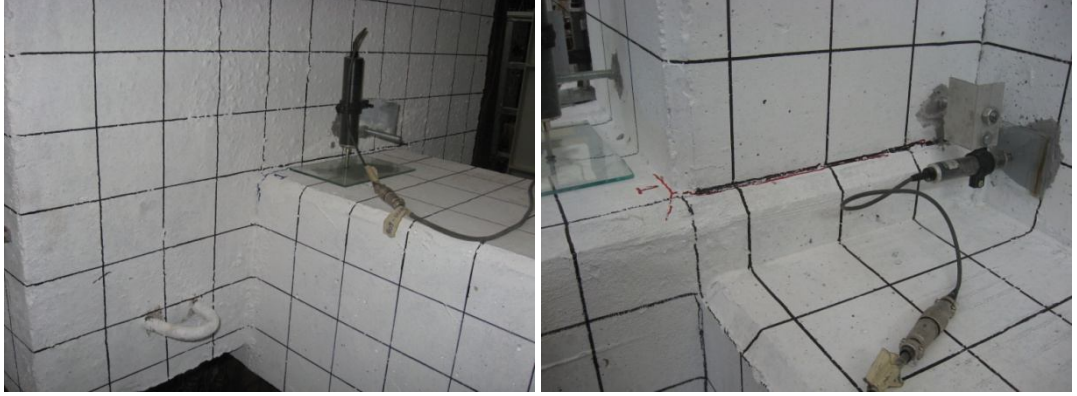
Şekil 2.63 : 1. çevrim grubu sonucu numunede oluşan hasar durumu
