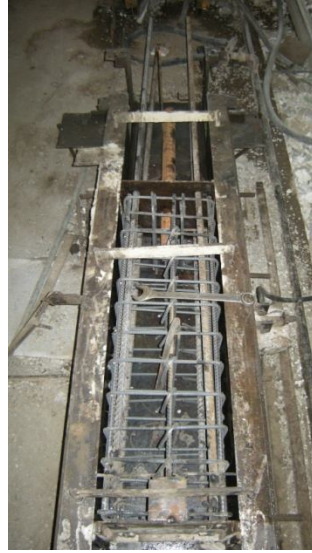
Şekil 2.12 : Numune donatılarının kalıba yerleşimi
