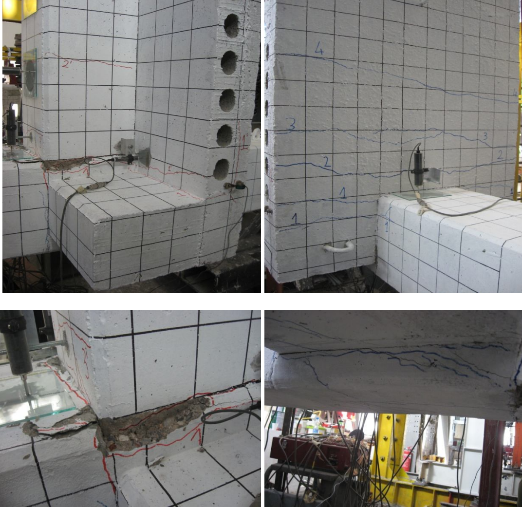
Şekil 2.65 : 4. ve 5. çevrim grubu sonucu numunede oluşan hasar durumu
