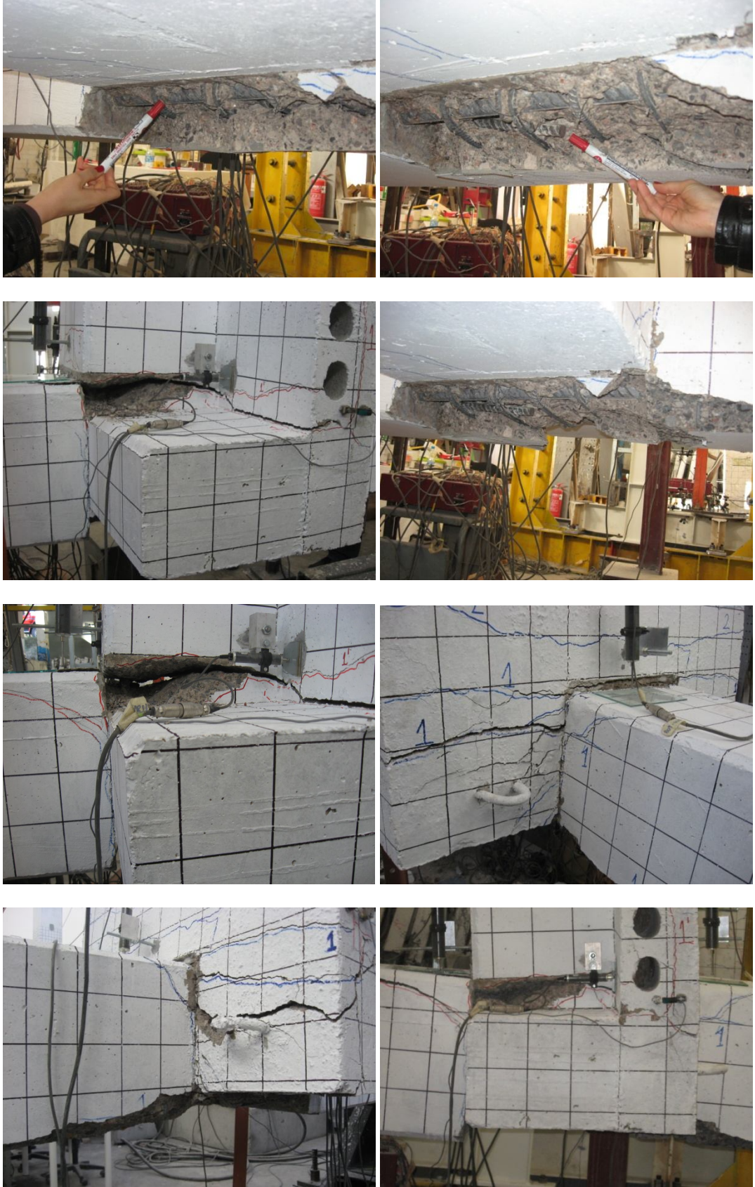
Şekil 2.66 : Son 5 çevrim grubu sonucu numunede oluşan hasar durumu
