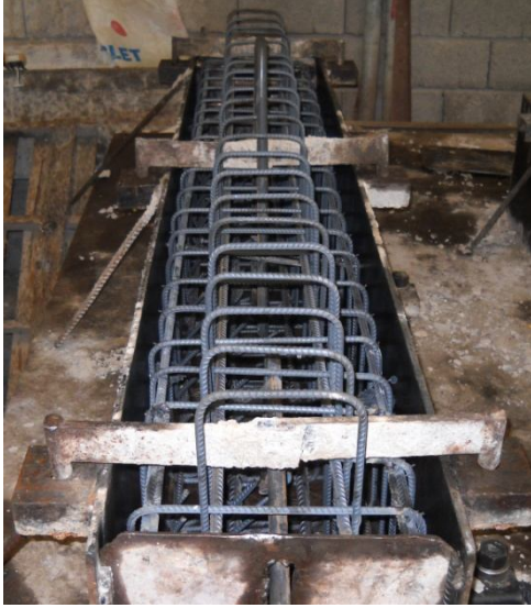
Şekil 2.12 : Numune donatılarının kalıba yerleşimi
