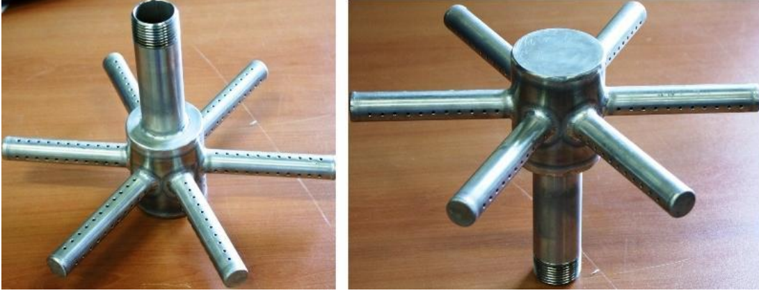
Şekil 5.6: Tasarlanan örümcek tipi gaz dağıtıcı
