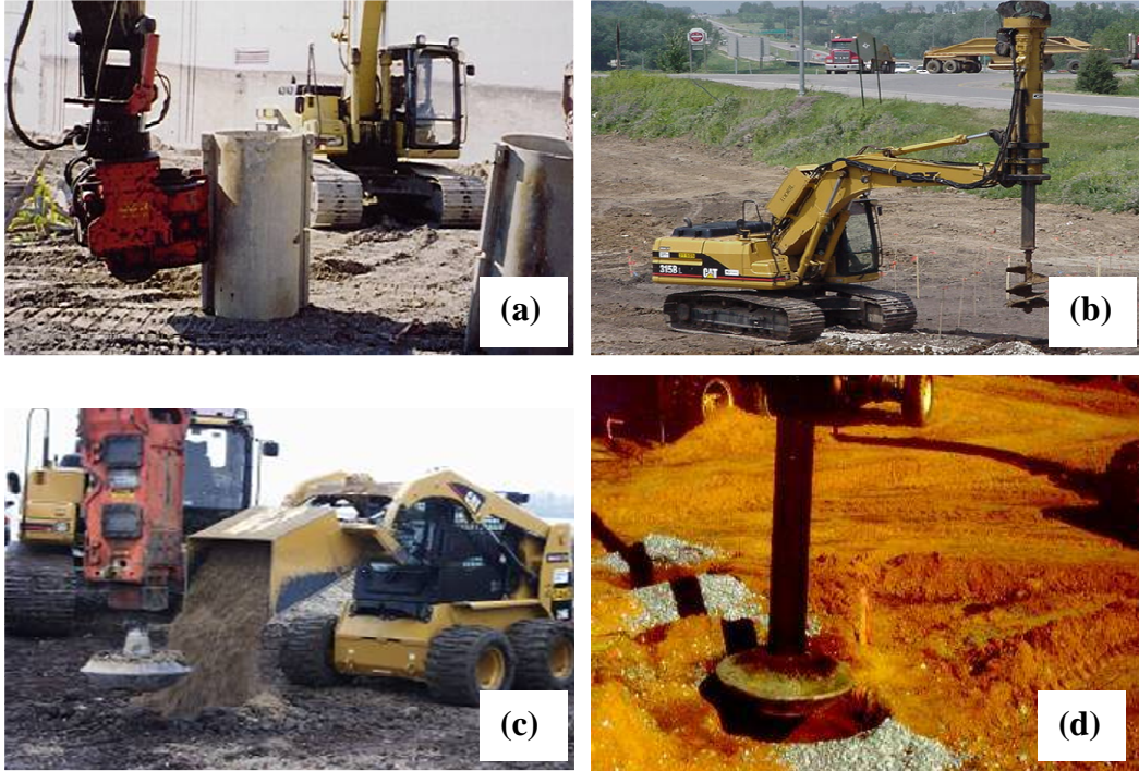
Şekil 3.3 : Geopier sistemi ekipmanı (Geopier® Foundation Company, Inc., 2009).
