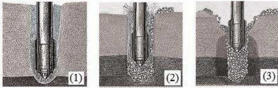
Őekil 2.2 : Vibro yer deęiřtirme yntemi imalat adımları (Url-1).
