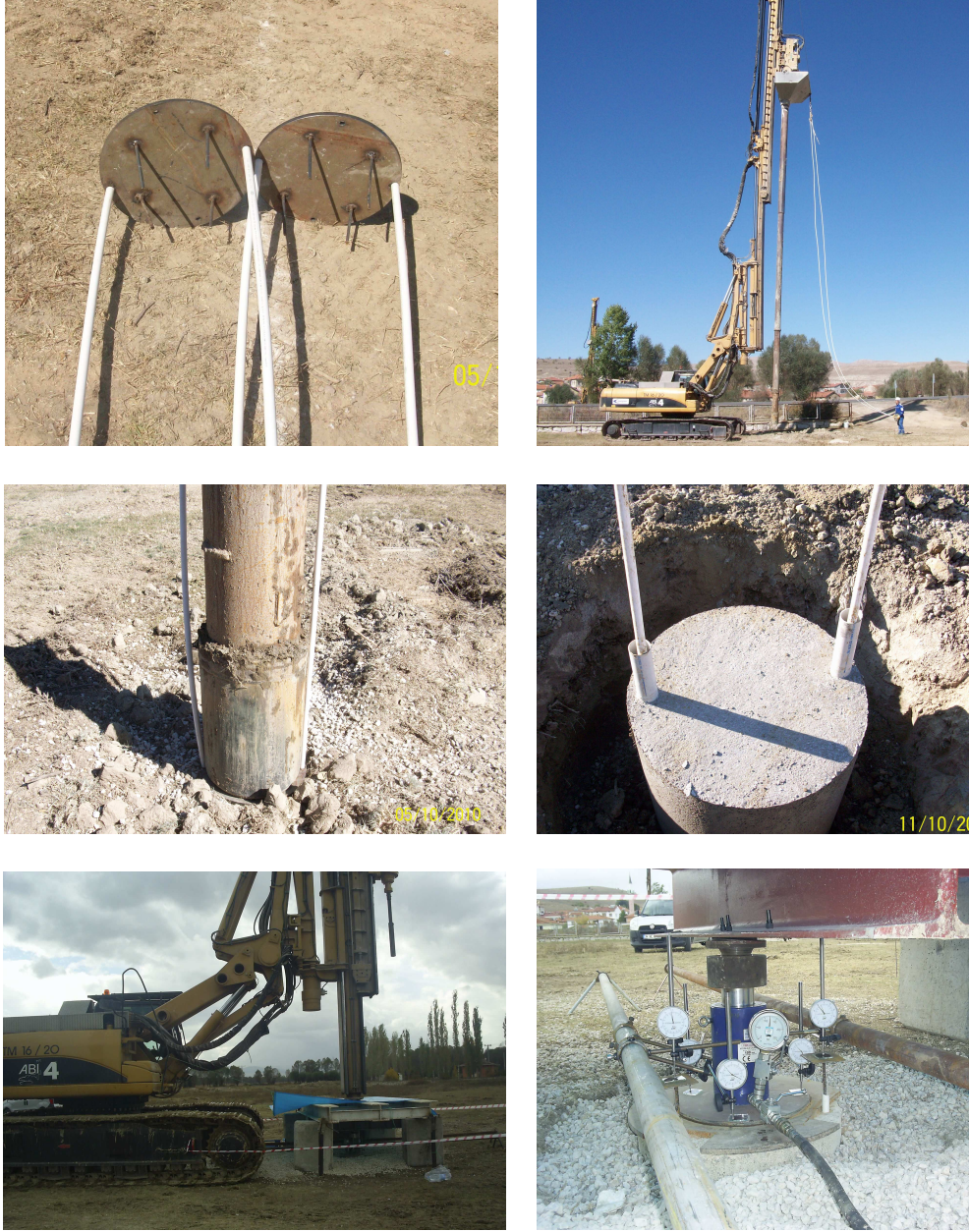
Şekil 3.17 : Yükleme testi düzeneği.
