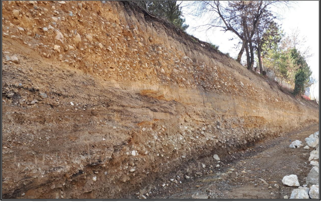
Fotoğraf 26. Karabük merkezde açılan profilde fizyolojik derinliği fazla olan ve çeşitli boyutlardaki unsurların farklı dönemde hâsıl olduğu kolüvyal toprak
