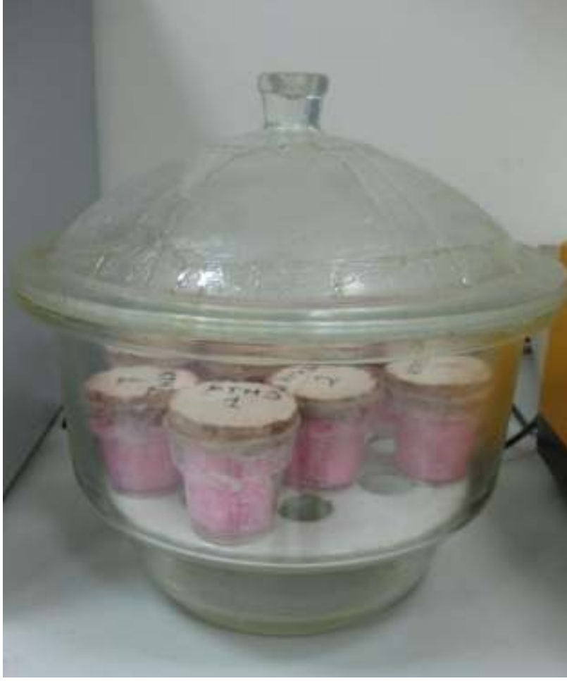
Şekil B.3 : Buhar geçirgenlik deneyi için desikatörde bekletilen numuneler.
