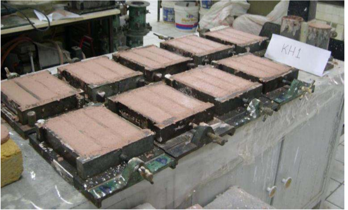
Şekil B.2 : 4x4x16cm lik prizmatik kalıplara dökülen harç numuneleri.
