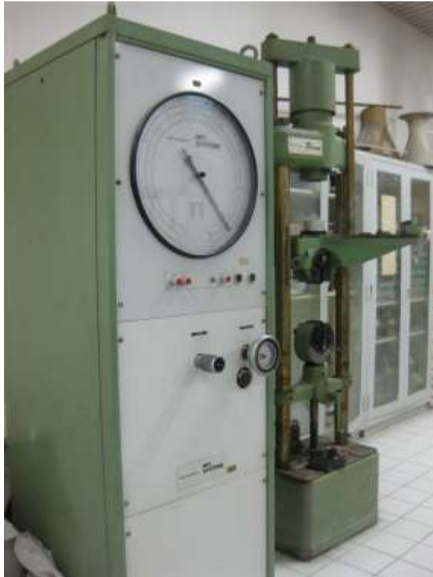
Şekil 4.10 : Eğilme ve basınç deney düzeneği.
