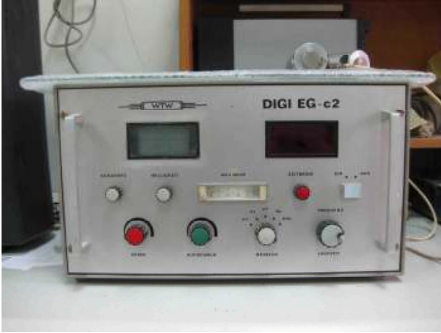
Şekil 4.7 : Ultrases hızı ölçüm cihazı.
