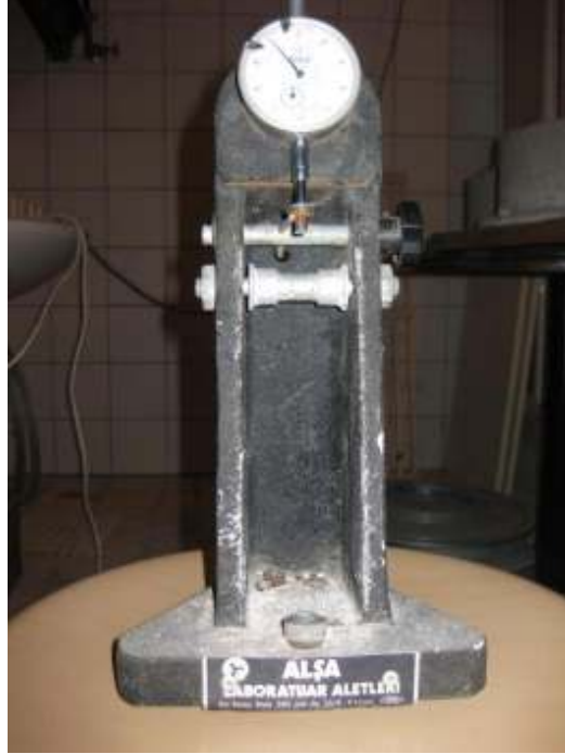
Şekil 4.5 : Rötire deney aleti.
