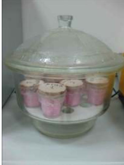
Şekil 4.8 : Buhar geçirgenlik deney numuneleri.
