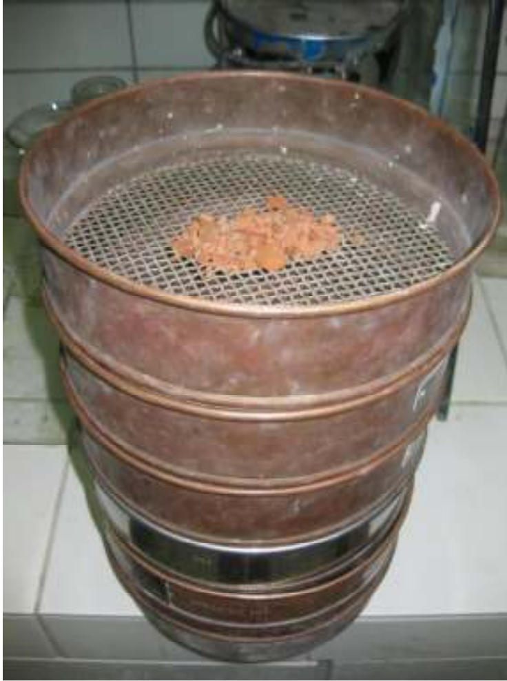
Şekil B.8 : Asit kaybı analizi sonrası asitte çözünmeyen kısmın elek analizi.
