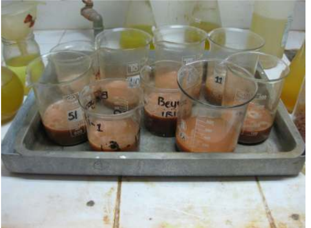
Şekil B.6 : Asit kaybı analizinde beherde asit ile reaksiyona giren harç numuneleri.
