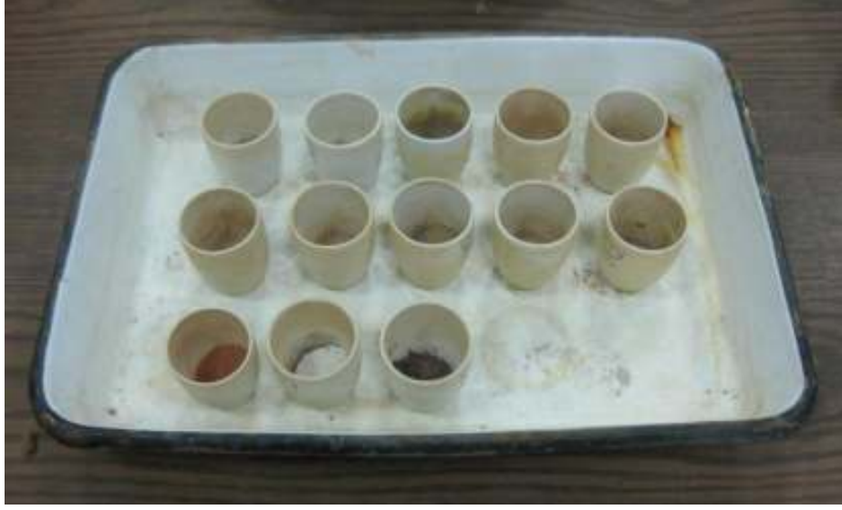
Şekil B.9 : Kızdırma kaybı analizinde kröze içerisine konulmuş öğütülmüş harç numuneleri.
