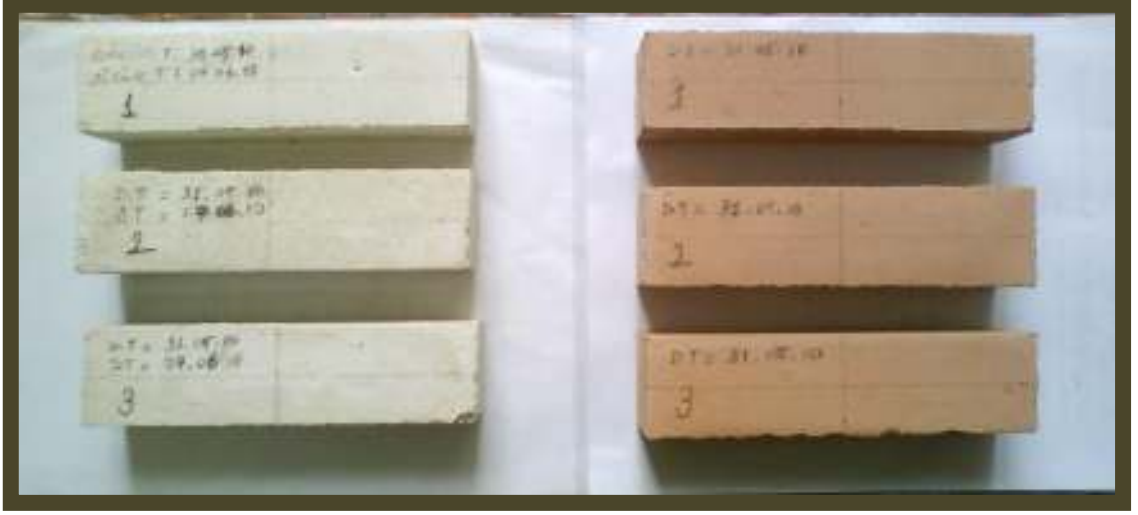
Şekil B.1 : Pozzolanik aktivite için ponza taşı tozu ve tuğla tozu ile üretilmiş kireç harcı örnekleri.
