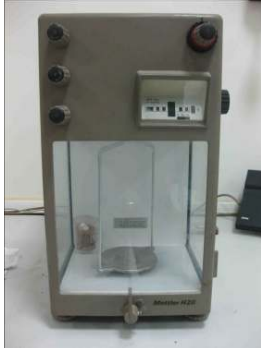
Şekil 4.9 : Mettler H20 marka elektronik terazi.
