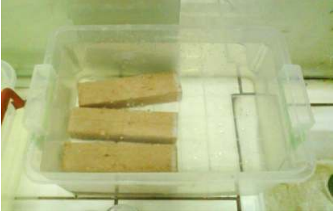
Şekil B.5 : Su emme deneyi.
