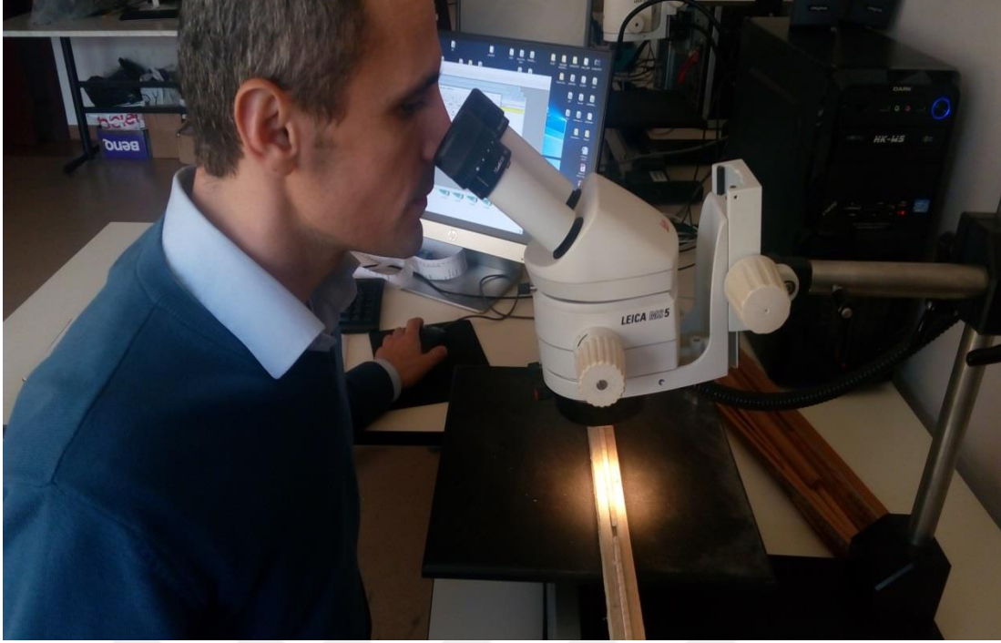
Foto 5. Yıllık halka genişliklerinin LINTAB-TSAP ölçüm sistemiyle ölçülmesi (Örnekler İstanbul Üniversitesi Orman Fakültesi Dendrokronoloji Laboratuvarında 0.01 mm duyarlılıkta ölçülmüştür).
