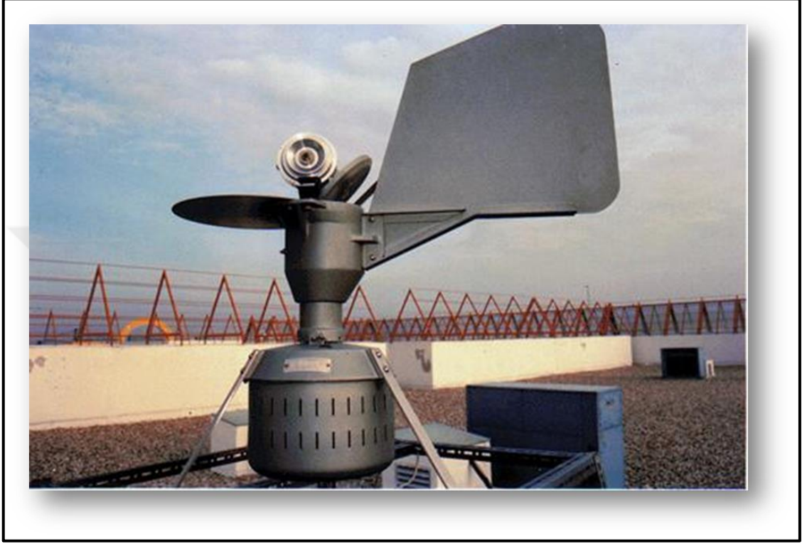
Fotoğraf 13. Hirst (Burkard) Tipi Sensör (URL 12).
