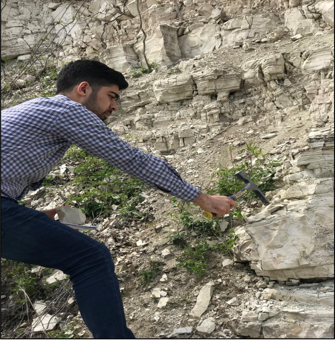
Fotoğraf 20. Çalışma sahasında belirlenen bazı noktalardan XRF analizi yapmak amacıyla kayaç numunesi toplanması.
