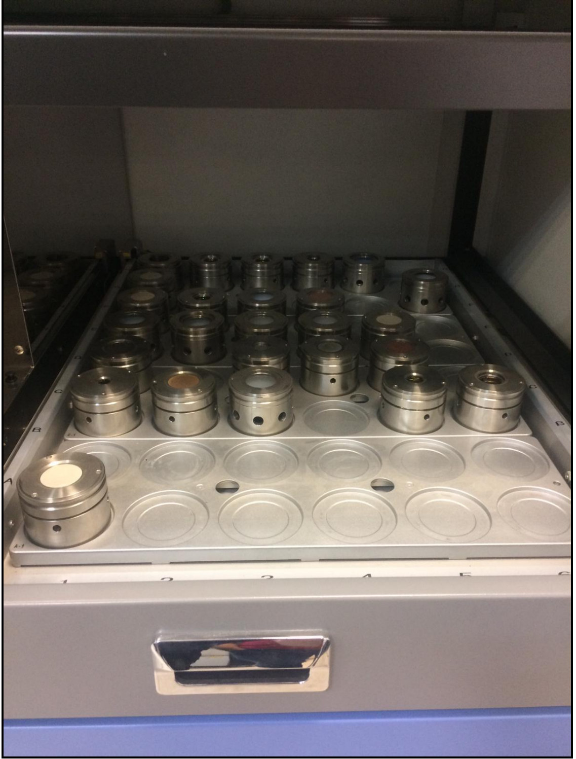
Fotoğraf 65. XRF analizi yapan cihaz.
