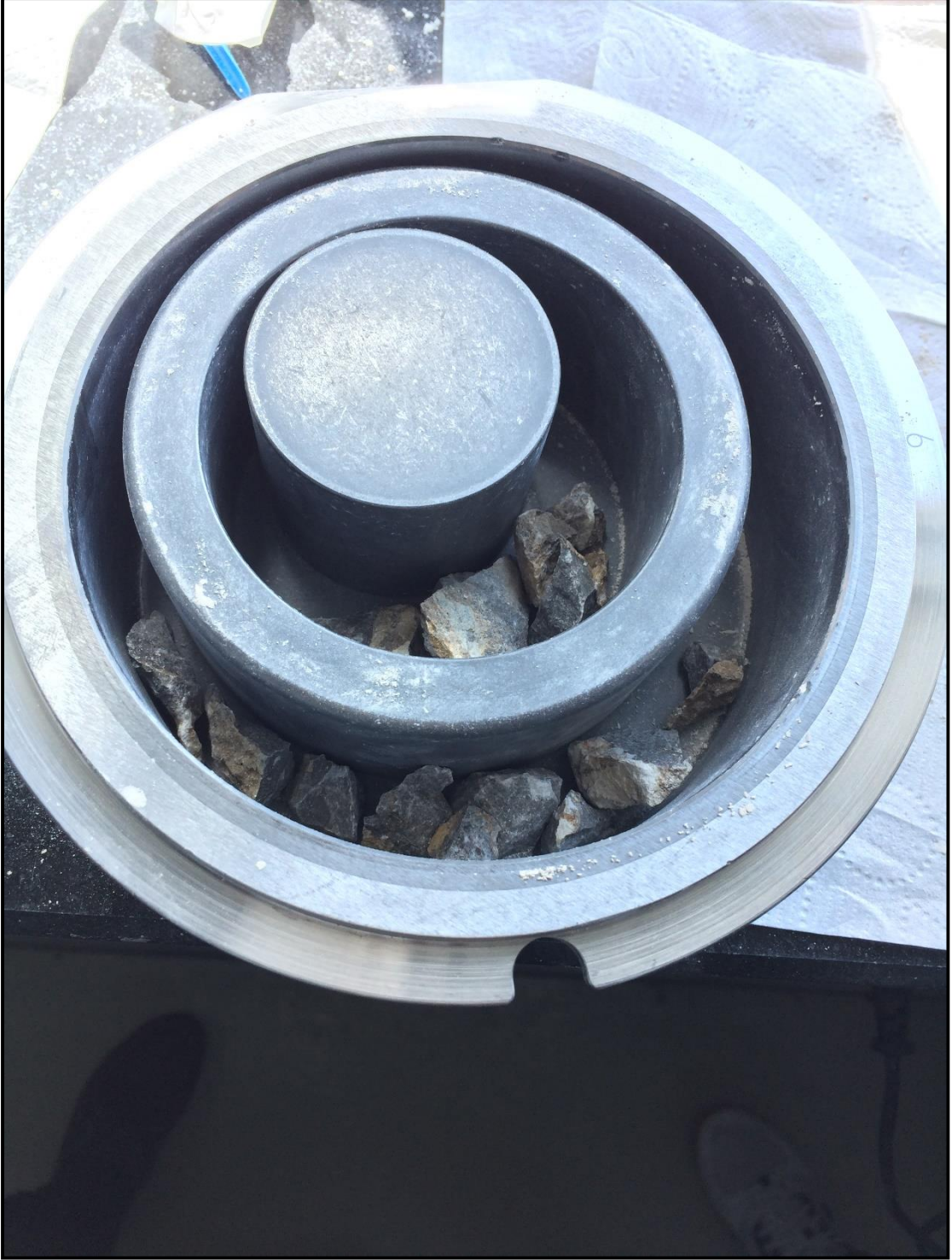
Fotoğraf 67. Numunelerin öğütülmeden önceki durumu.
