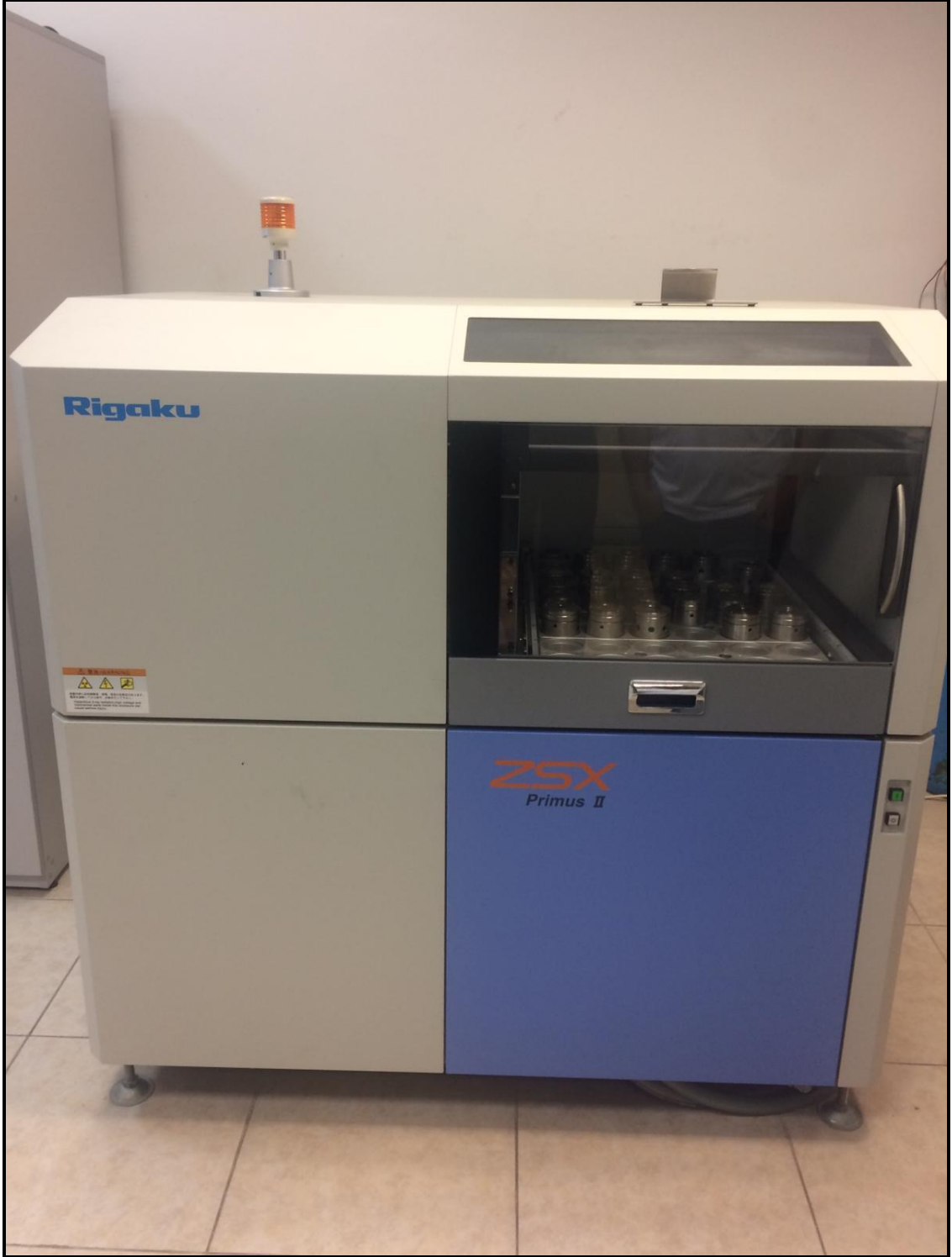
Fotoğraf 64. XRF analizi yapan cihaz. 10 adet kayaç numunesinin XRF analizi Karabük Üniversitesi Demir-Çelik Enstitüsünde yapılmıştır.
