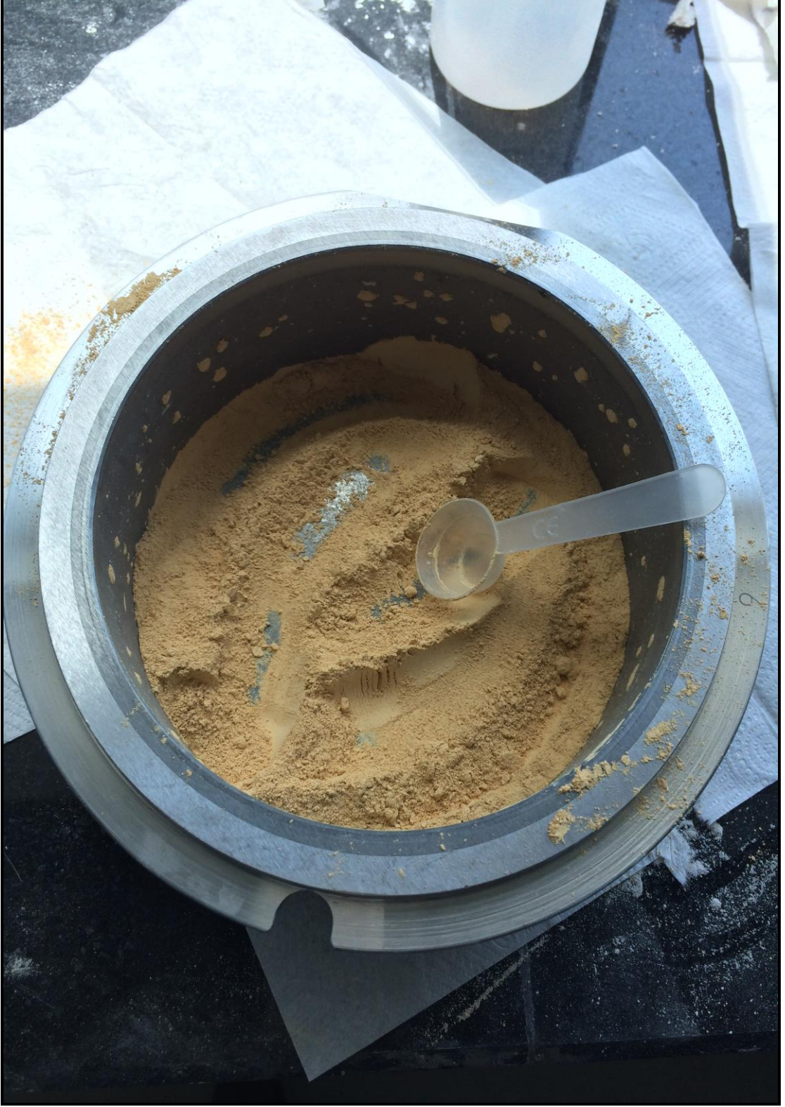
Fotoğraf 69. Numunelerin öğütüldükten sonraki durumu.
