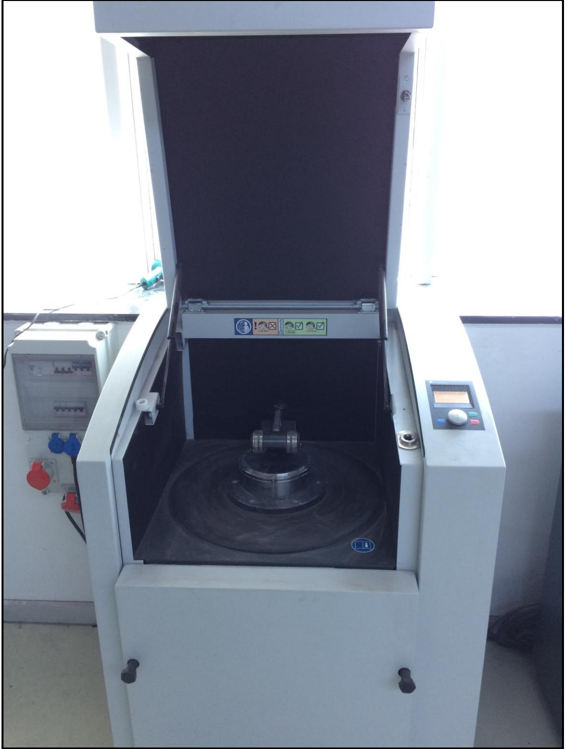
Fotoğraf 19. Kayacı oluşturan minerallerin oranları ve kayacın yapısal özellikleri ile türünün belirlenmesi için Karabük Üniversitesi Demir-Çelik Enstitüsü laboratuvarında öğütme yapan makine.
