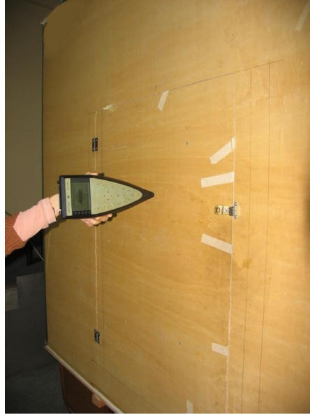
Şekil 6.5 : Brüel & Kjaer 2260 Investigator Ses Düzeyi Ölçer ile ses basıncı ölçümü.
