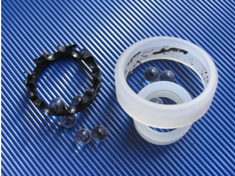
Şekil 7.11 : Kafesi parçalanmış bilyalı yatak.
