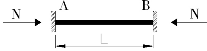
Şekil 3.7: İki ucu ankastre tek duvarlı çubukta
