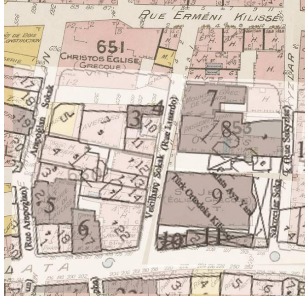
Şekil 3.25 : 1-B alt bölgesi için Goad haritası, günümüz İBB haritası çakıştırması ve tescilli yapılar.
