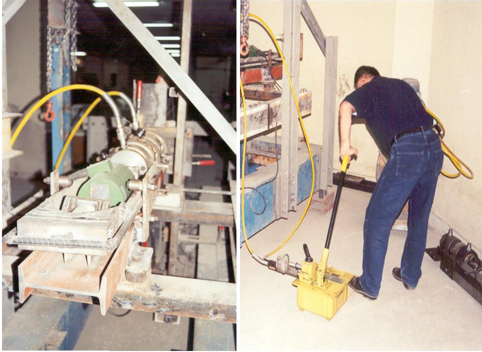
Şekil 10.16 : Deneyde kullanılan yük ölçüm düzeneği ve deneylerde kullanılan yükleme sistemi [24].
