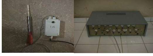
Şekil 10.17 : Yer değıştirme ölçüm sistemi ve yük ve yedeğiştirme okumalarını değerlendiren data logger sistemi [24].
