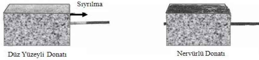
Şekil 3.2 : Yetersiz Kenetlenmenin Etkileri
