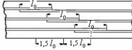
Şekil 3.14 : Çekme Kuvveti Taşıyan Donatıların Şaşırtmalı Bindirme Eki [17]
