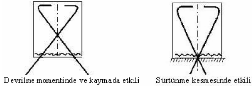
Şekil 5.7 : Kısa Konsol Perdelerde Çapraz Donatı Düzenleri [5]
