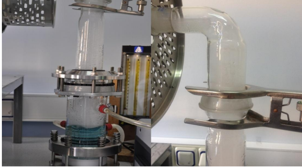
Şekil 4.6 : Ultrasonik atomizör içerisinde aerosol oluşumu ve oluşan aerosolün taşınımı.
