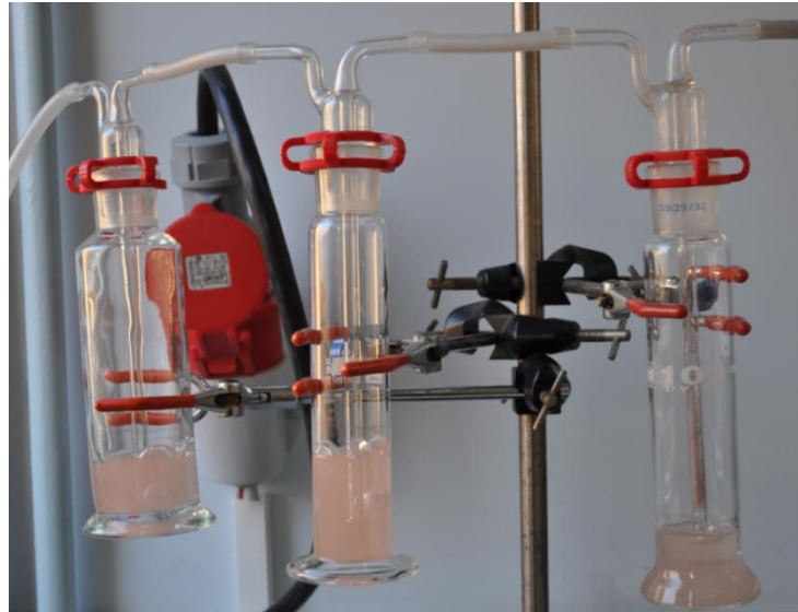
Şekil 4.7 : Partiküllerin etanol içeren gaz yıkama şişelerinde birikmesi.
