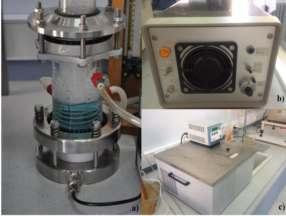
Şekil 4.2 : Deney düzeneğini oluşturan a) atomizör b) güç kaynağı c) termostat.
