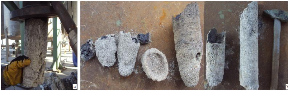
Şekil 2.8 : Yatak bağlamasına ait fotoğraflar (a) Reaktördeki ergimiş yatak (b) Reaktörden çıkan ergimiş kül ve yatak malzemesi.
