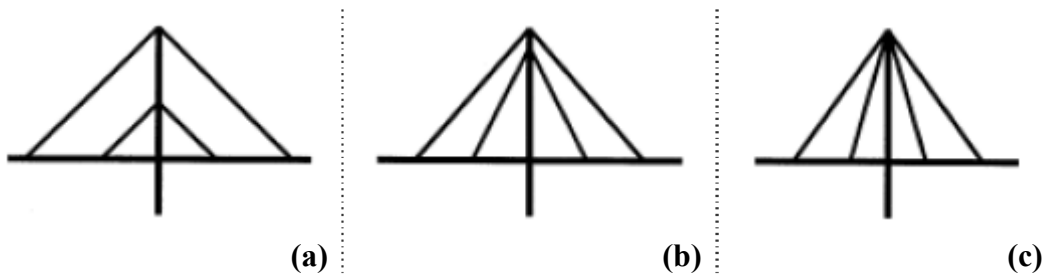
Şekil 2.7 : Kablo bağlantı şekilleri: (a)Harp, (b)Fan, (c)Radial.
