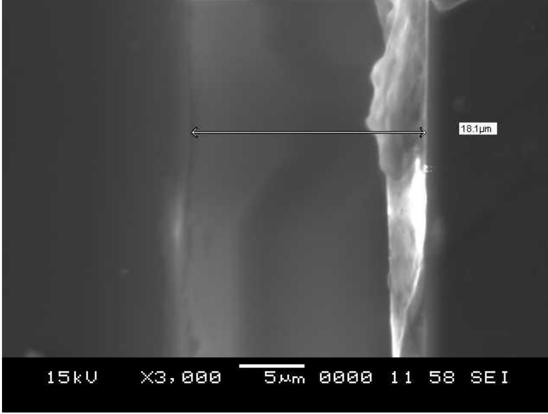
Şekil 4.11 : INSTEC firmasından alınan cam hücrelerdeki boşluk kalınlığı.
