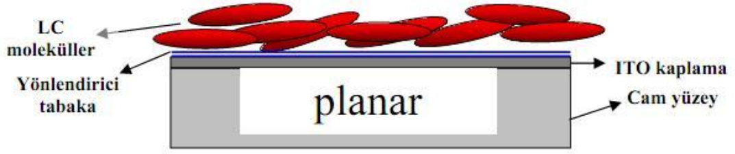
Şekil 4.5 : Sıvı kristal moleküllerinin planar (paralel) yönelimi [42].
