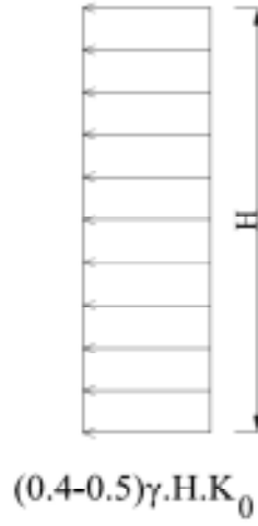
Şekil 2.9 : Navfac tarafından kohezyonsuz zeminler için önerilen toprak basıncı dağılımı.
