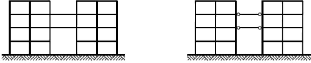
Şekil 2.14 : İki yapıyı birleştiren elemanlarda moment aktaran ve aktarmayan bileşimler(Celep ve Kumbasar 2004).
