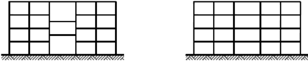
Şekil 2.15 : Düşeyde kiriş süreksizliği içeren ve içermeyen tipik örnekler (Celep ve Kumbasar 2004).
