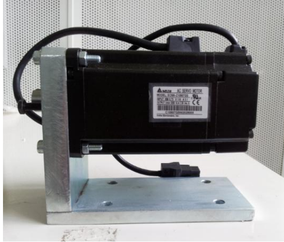
Şekil 5.30 : Egzoz klapesi kontrolü için kullanılacak servo motor.
