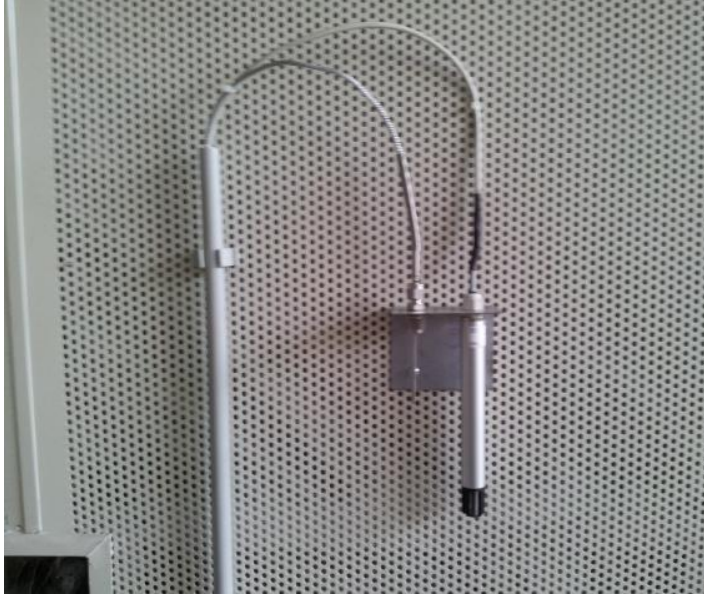
Şekil 5.20 : Sıcaklık (solda) ve nem sensörü (sağda).
