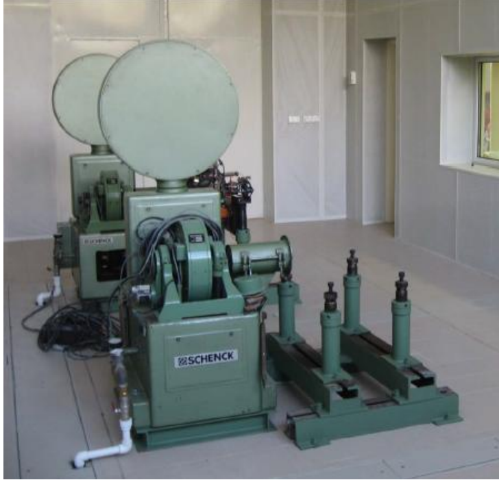
Şekil 5.7 : Motor freni ve motor bağlantı ayaklarının montajı.
