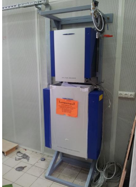
Şekil 5.28 : AVL 733S/753CL yakıt ölçüm ve şartlandırma sistemi.
