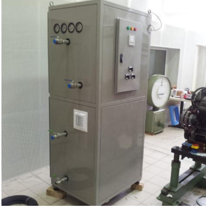
Şekil 5.26 : Motor suyu ve yağı şartlandırma sistemlerinin genel görünümü.
