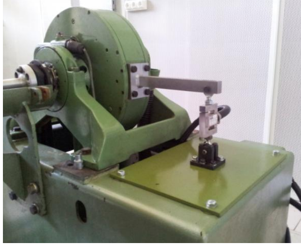
Şekil 5.15 : “Load cell”-dinamometre bağlantısı.
