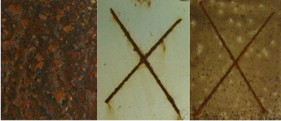
Şekil 4.11 : Tuz püskürtme testi uygulanan çapraz çizgili plakalar: (a) başlangıç ve (b) 60 saat sonra ki görüntüleri.
