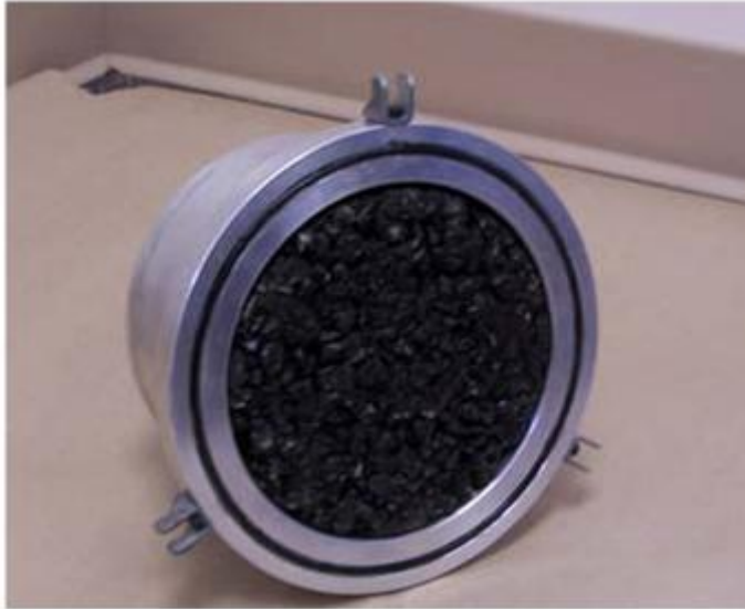
Şekil 4.14: Empedans Tüpü içindeki Örnek [8]
