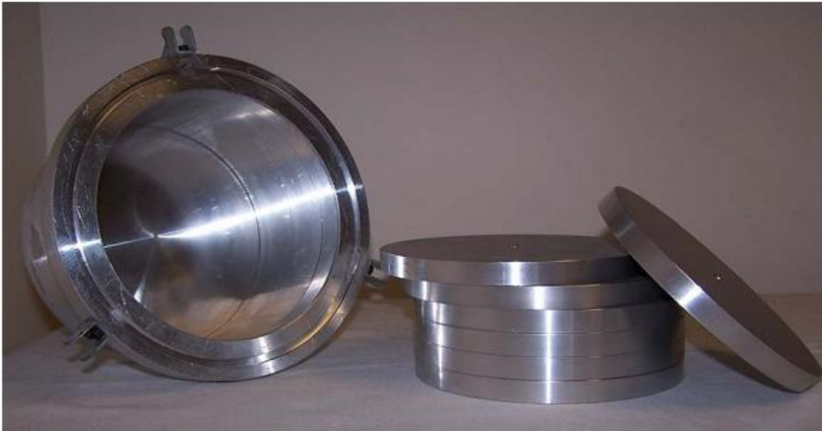
Şekil 4.16: Asfalt film Uygulamasında Kullanılan Kalıplar
