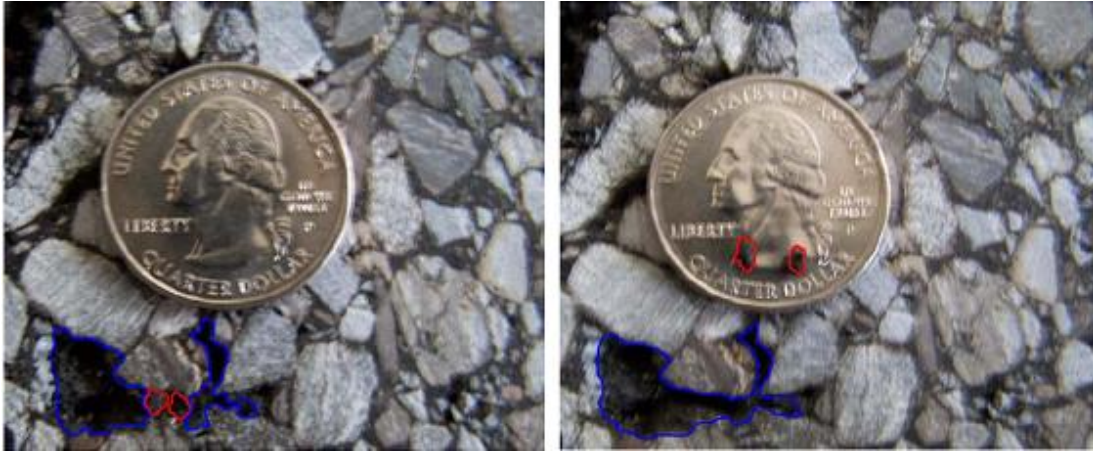
Şekil 4.35:Hava Akış Kanalları Tıkalı-Açık[8]
