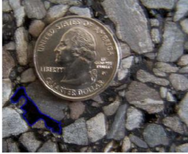
Şekil 4.34:Hava Boşluğu (SBS modifiyeli, bağlayıcı I tipli AGST için) [8]
