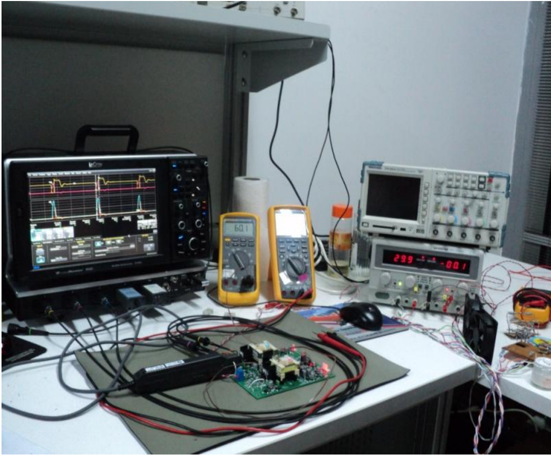
Şekil 4.8 : Kartın testleri ve kullanılan ekipmanlardan bir görünüm.
