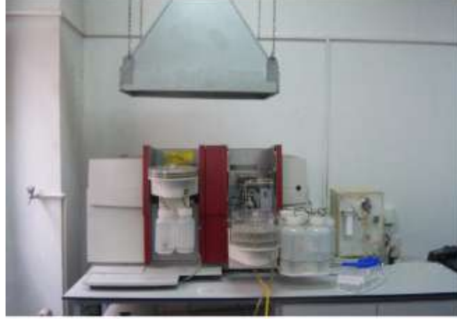
Şekil 3. Atomik Absorbsiyon Spektrometre Cihazı (www.megep.gov.tr. Erişim tarihi: 21 Mayıs .2018).
