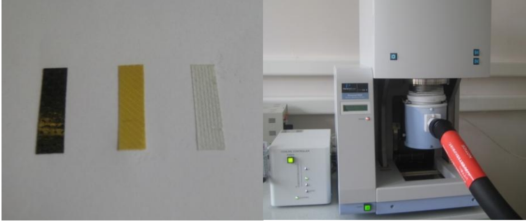
Şekil 2.12 : Karbon, Kevlar ve Cam numuneler. Perkin Elmer Diamond DMA.
