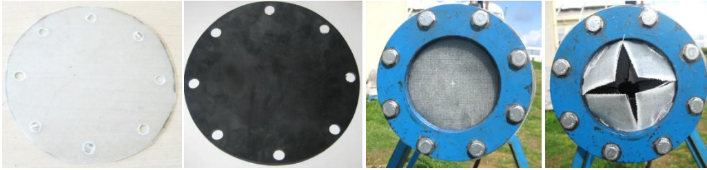
Şekil 2.23 : Membranların yırtılmadan önceki ve sonraki durumları.
