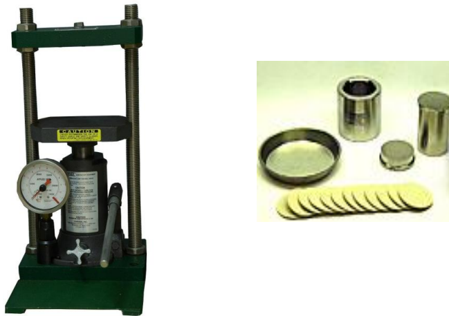
Şekil 2.1 : Soğuk pres cihazı ve aparatları.
