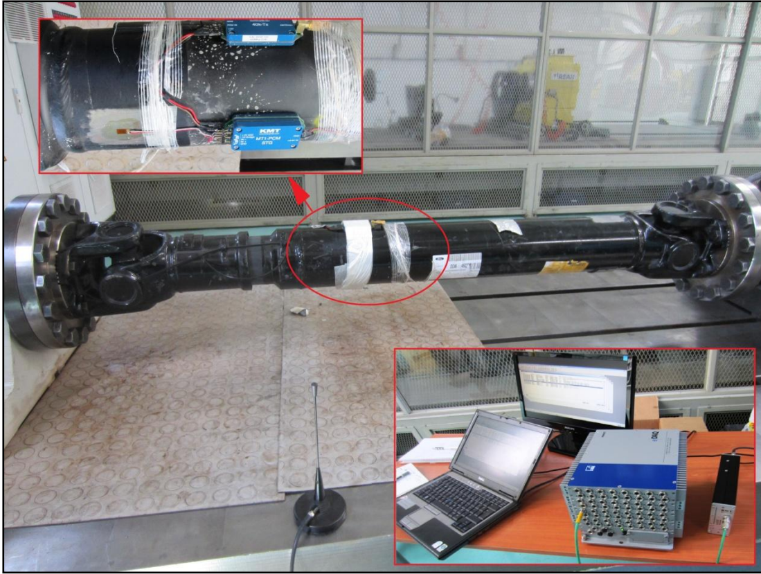
Şekil 4.6: Test ekipmanına mafsallanmış kardan şaftı ve telemetri sistemi.
