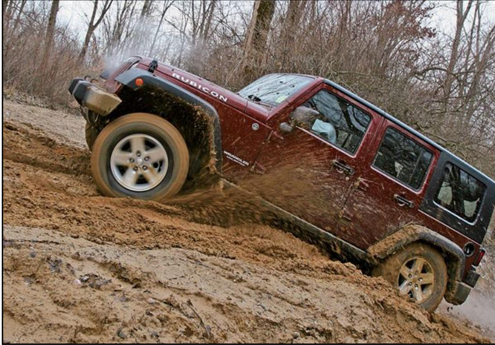
Şekil 3.2: Başlangıç torkunun tekerlek kuvvet bağlantısı torkundan büyük olması sonucu ortaya çıkan tahrik tekerleğinde kayma durumu.
