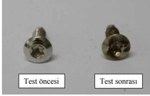
Şekil 5.24: Modifiye sıcak su testinden geçemeyen vidanın test öncesi ve sonrası görüntüleri.
