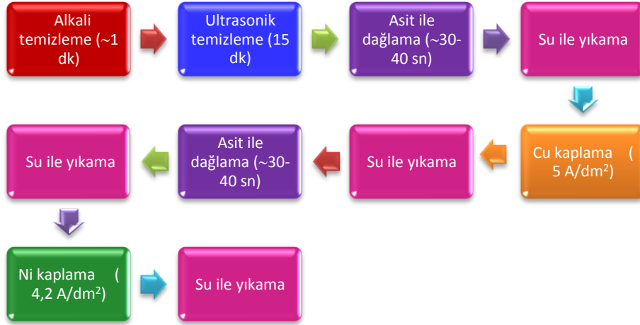
Şekil 4.4: Elektrolitik nikel kaplama prosesi akış şeması.
