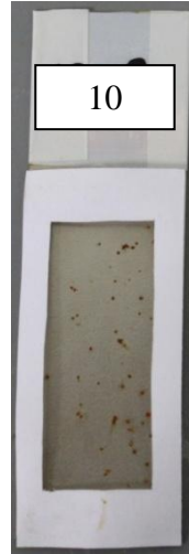
Şekil 5.20: Nikel kaplamalı plakalar için tuzlu su sisi test şablonu.
