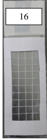
Şekil 5.4: Çinko kaplamalı plakalar için tuzlu su sisi test şablonu.
