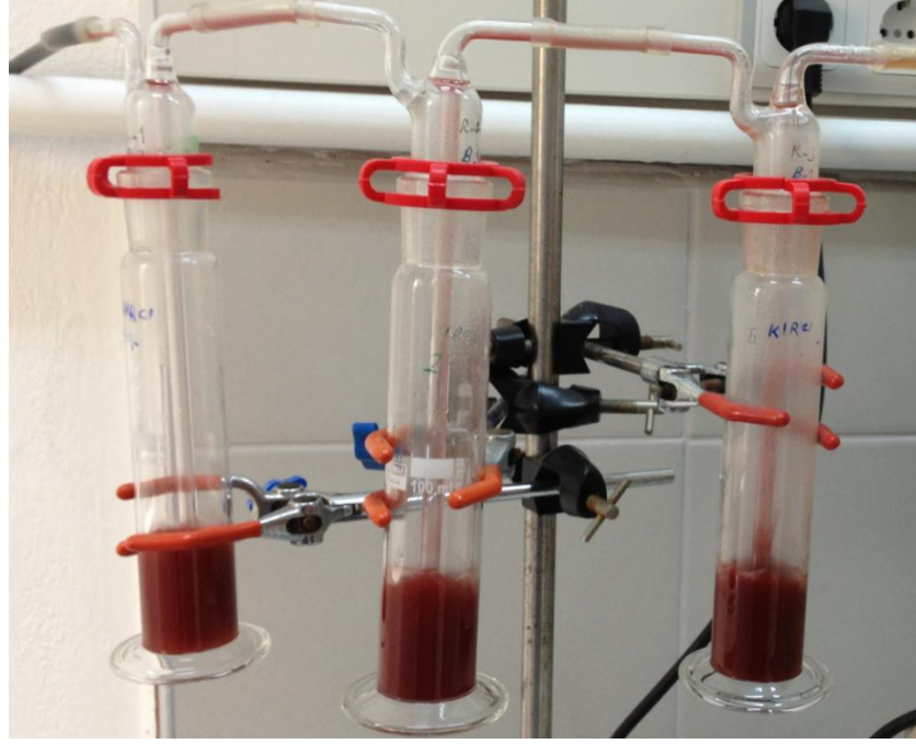
Şekil 6.4: Gaz yıkama şişelerinde toplanan hematit partikülleri.
