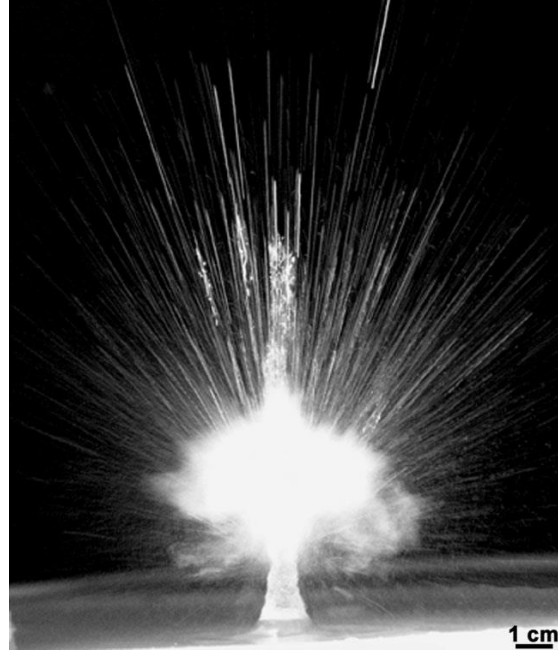
Şekil 3.1: Ultrasonik ses dalgası ile aerosol ve gayser oluşumu [21].
