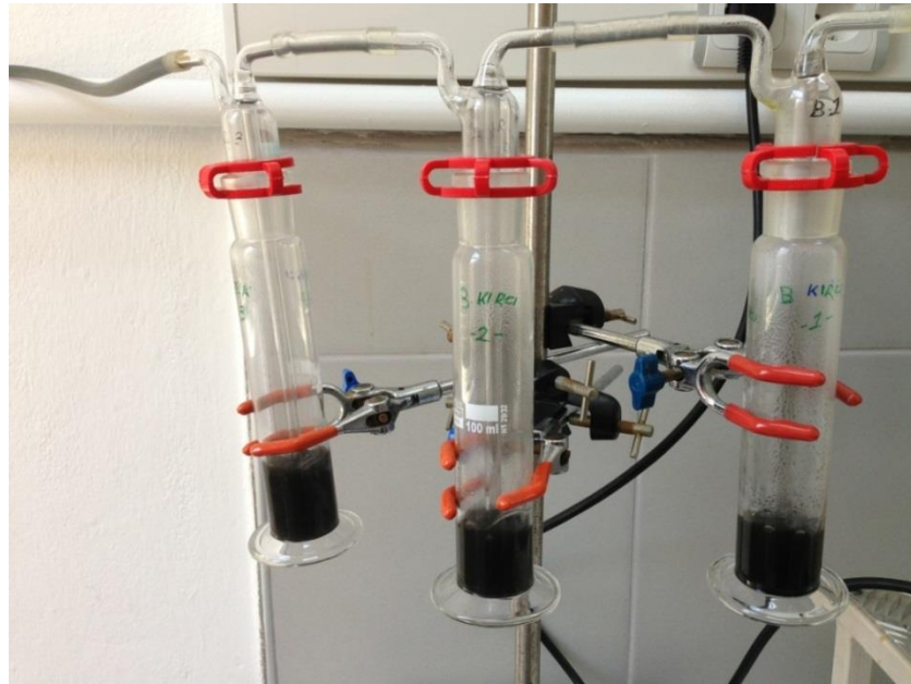
Şekil 6.5: Gaz yıkama şişelerinde toplanan manyetit partikülleri.
