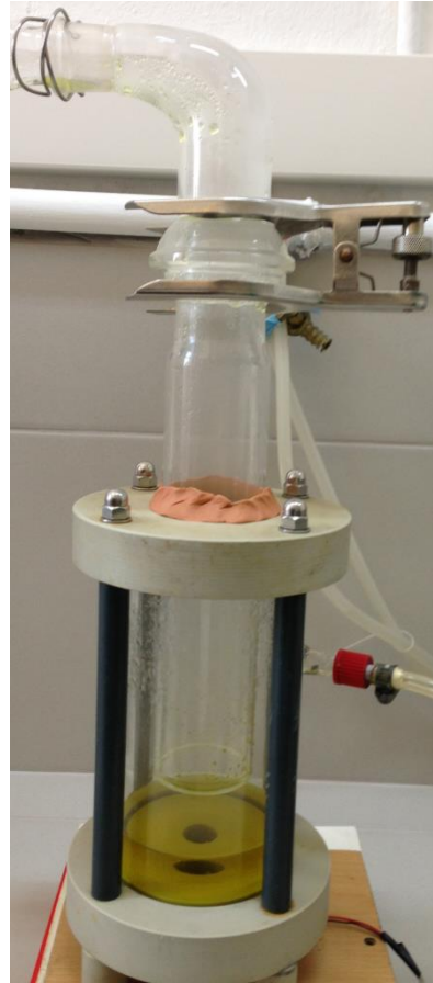
Şekil 6.3: Atomizör ve \text{FeCl}_2 çözeltisi.
