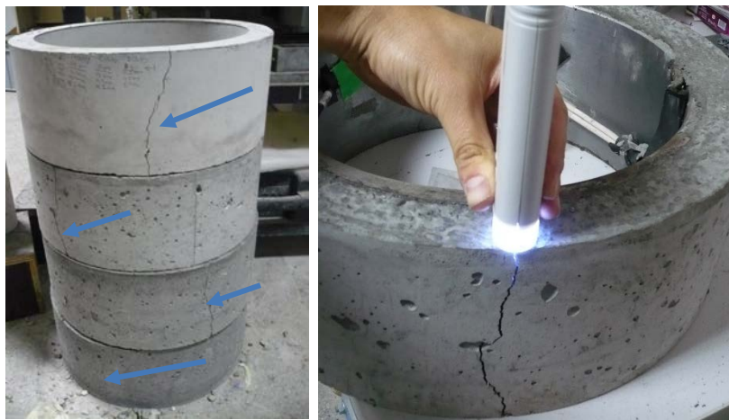
Şekil 4.6 : Halka deneyi çatlak yerleri (sol) ve çatlak mikroskobu (sağ).
