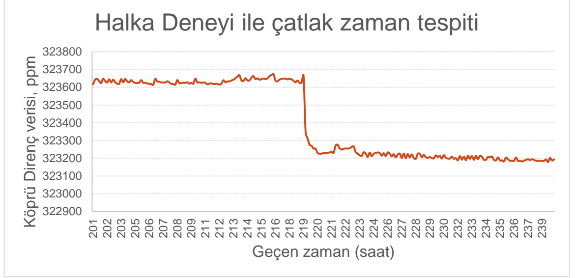
Şekil 4.5 : Gerinim ölçümleri ile çatlak oluşum zamanı (Döküm No 3).
