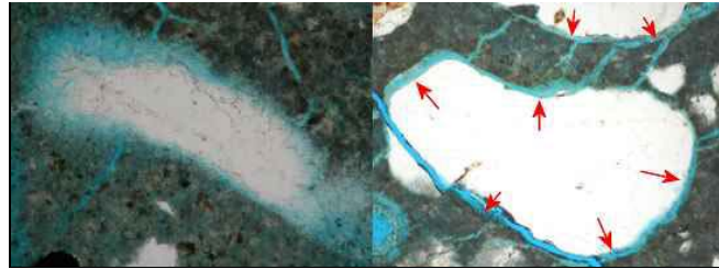
Şekil 2.3 : GE Oluşumu - Agrega çevresi mikro çatlakların mavi mürekkep enjekte edilmiş görüntüsü [6].
