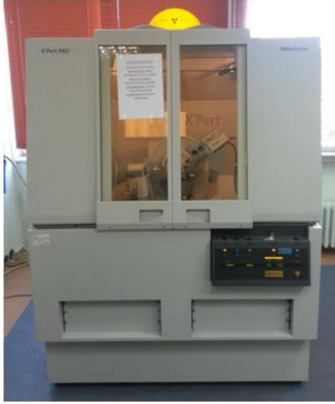
Şekil 3.4 : Kullanılan XRD cihazı.
