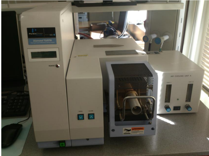
Şekil 3.5 : Analizlerde kullanılan TG/DTA cihazı.
