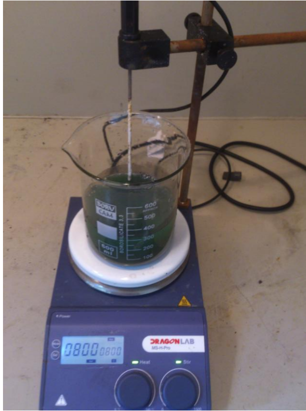
Şekil 3.7 : Deneylerde kullanılan liç düzeneği.
