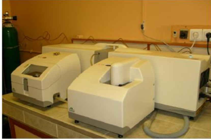
Şekil 3.3 : Toz boyut analiz cihazı.
