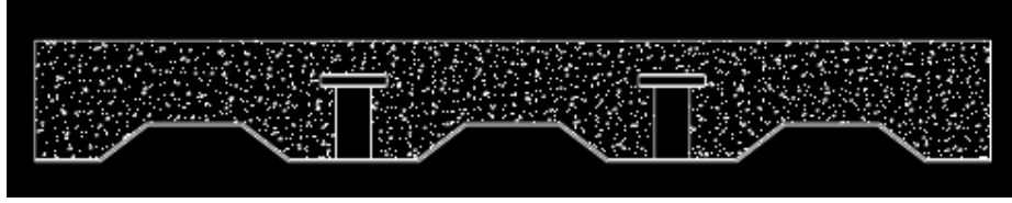
Şekil 6.12 : Kompozit döşemede beton, trapez sac ve kayma kamaları.
