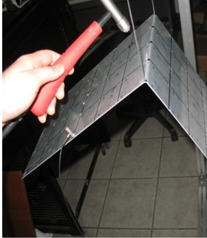
Şekil 4.10 : Serbest – serbest sınır şartına sahip L plaka.
